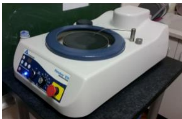
Slika 3.1. Uređaj za poliranje
