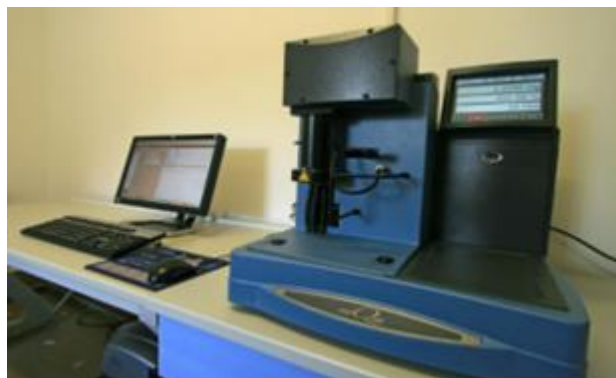
Slika 3.10. Uređaj korišten za provođenje termogravimetrijske analize.
