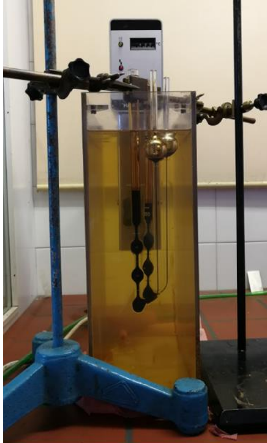
Slika 3.6. Prikaz termostatisrane uljne kupelji pri 40 °C i uronjenih viskozimetara za mjerenje viskoznosti.
