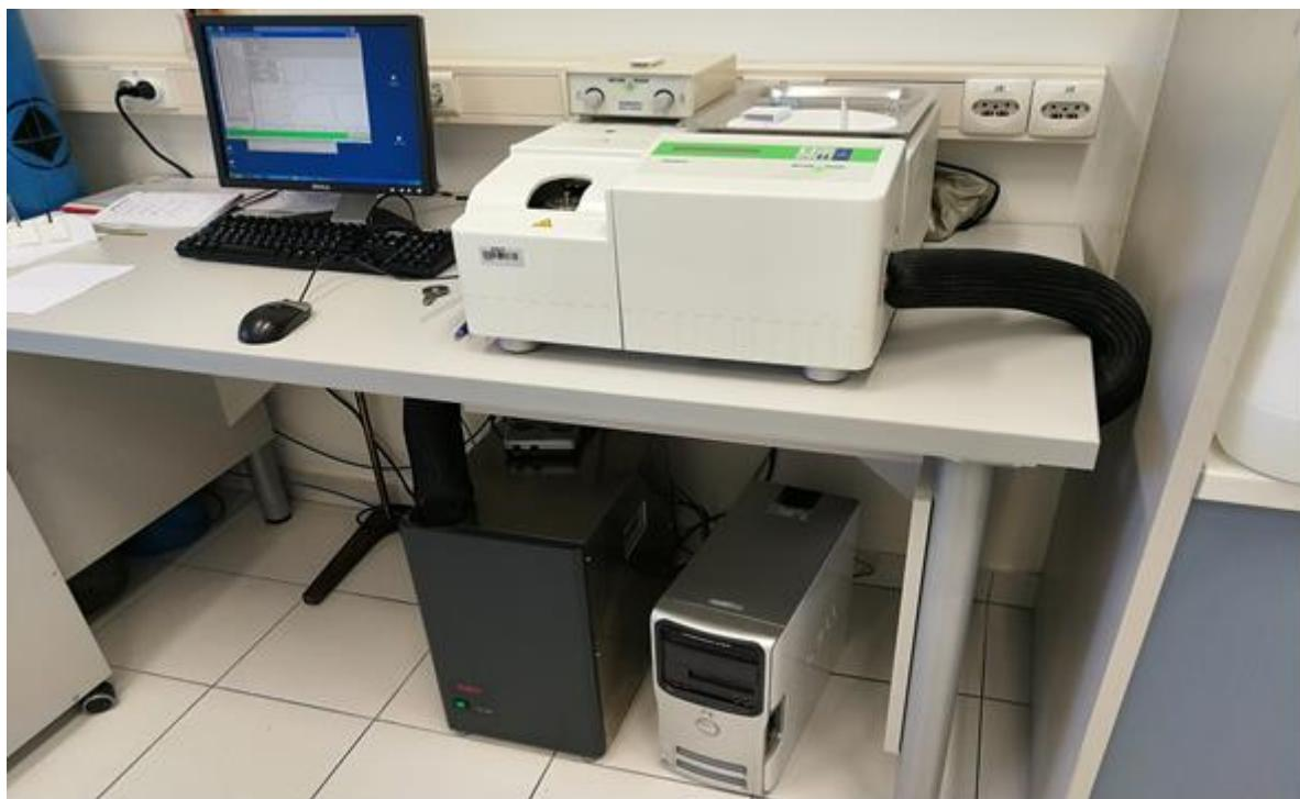
Slika 3.11. Diferencijalni pretražni kalorimetar Mettler Toledo s računalom.
