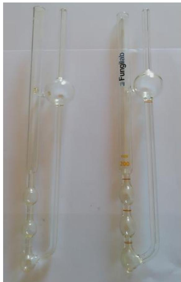
Slika 3.5. Viskozimetri korišteni za mjerjenje viskoznosti; lijevi za uzorke uzorkovane s vrha, dok je desni korišten za uzorke uzorkovane s dna.
