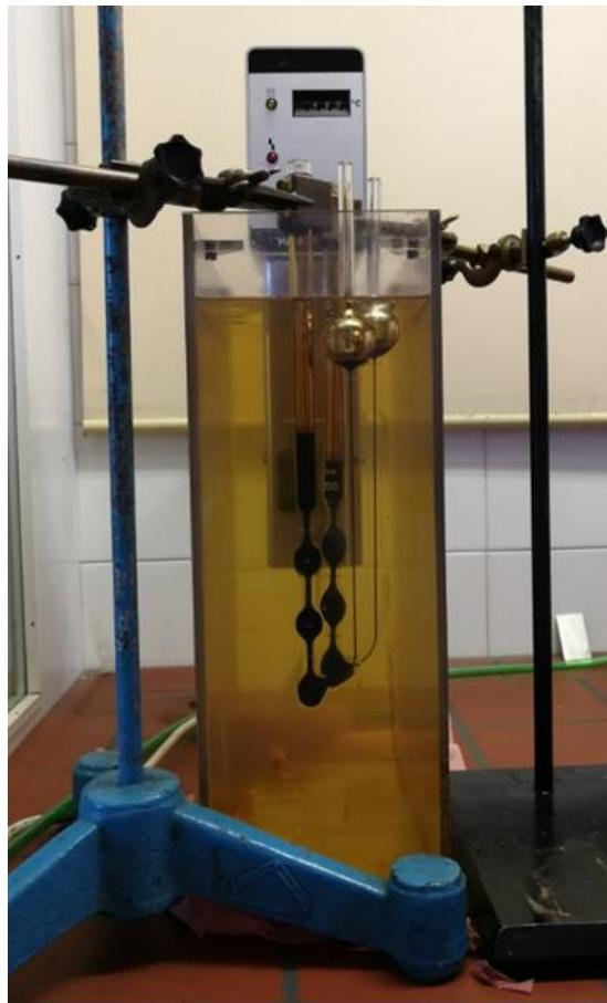
Slika 3.6. Prikaz termostatirane uljne kupelji pri 40 °C i uronjenih viskozimetara za mjerjenje viskoznosti.
