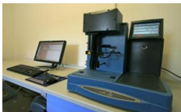
Slika 3.10. Uređaj korišten za provođenje termogravimetrijske analize.
