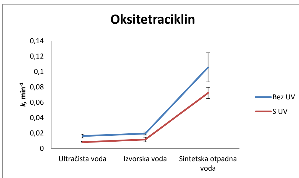
Slika 36. Ovisnost konstanti brzina razgradnje o utjecaju matrice, bez i s dodatkom UV-filtara
