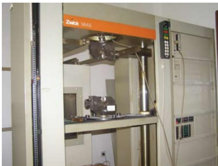
Slika 10 Kidalica ZWICK/RÖEL UTM 1445
