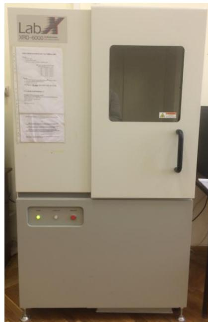
Slika 3.4. Shimadzu XRD-6000 difraktometar.
