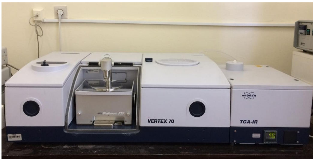
Slika 3.3. ATR-FTIR Bruker Vertex 70 spektrometar.
