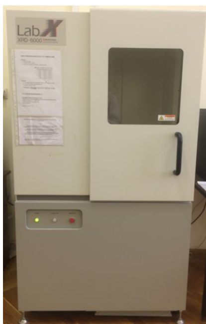
Slika 3.4. Shimadzu XRD-6000 difraktometar.
