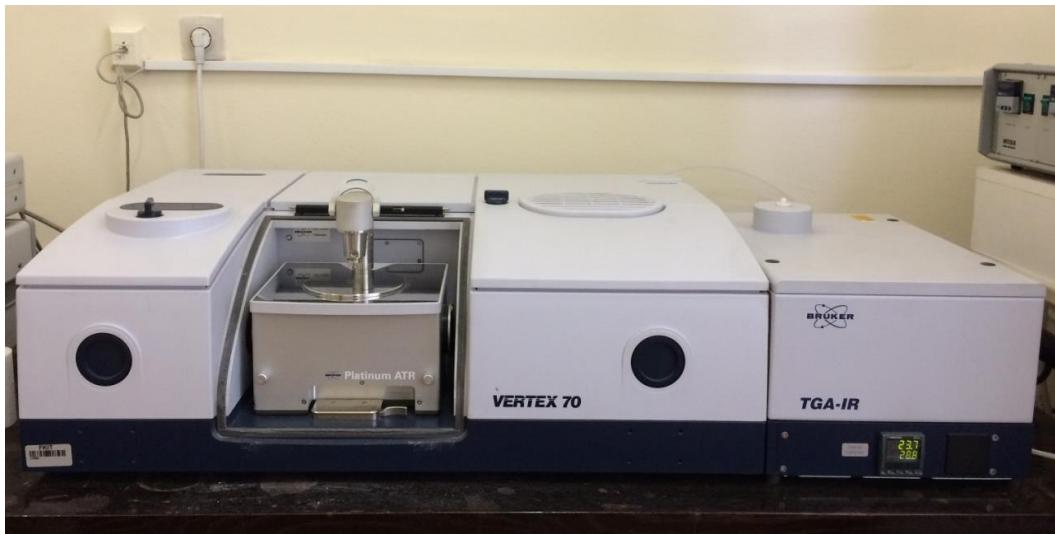
Slika 3.3. ATR-FTIR Bruker Vertex 70 spektrometar.
