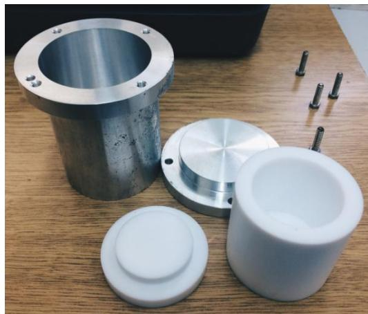
**Slika 9. Autoklav korišten za hidrotermalni tretman**
