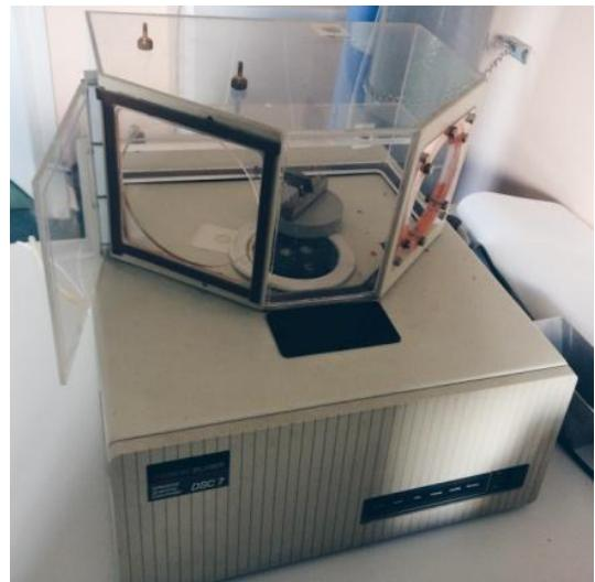
**Slika 13. Diferencijalni pretražni kalorimetar
