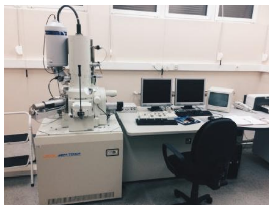
Slika 12. Pretražni elektronski mikroskop Jeol Jeol JSM-7000F
