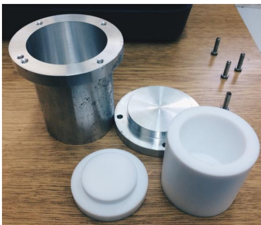
Slika 9. Autoklav korišten za hidrotermalni tretman
