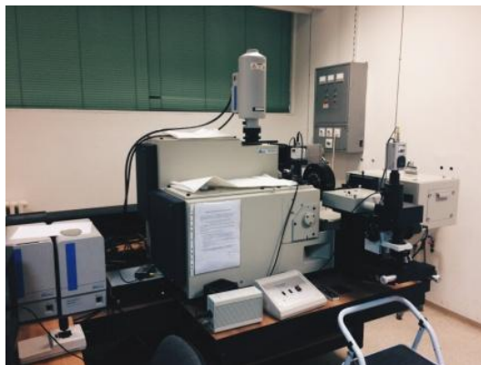
Slika 11. Ramanov spektrometar Jobin-Yvon T64000
