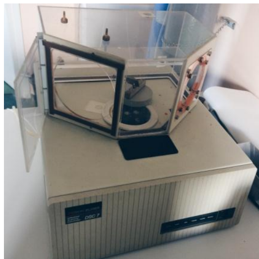
Slika 13. Diferencijalni pretražni kalorimetar Perkin-Elementer DSC , model 7
