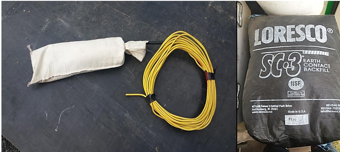
Slika 22. Inertna elektroda obložena koknim punilom u platnenoj vreći i nabavni koks [45]
