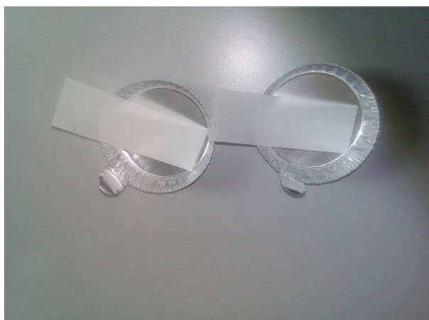
Slika 8. Prevlake dobivene kristalizacijom iz otopine na predmetnom stakalcu
