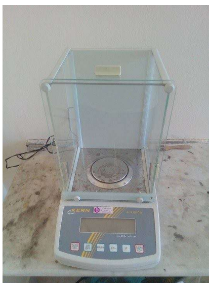
Slika 10. Analitička vaga ALS 220-4, Kern
