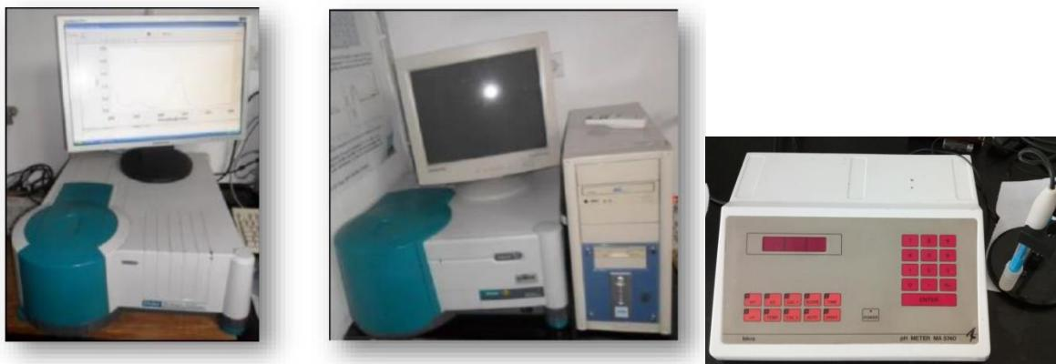
**Slika 13.** a) UV-vidljivi apsorpcijski spektrofotometar; b) fluorescencijski spektrofotometar,
