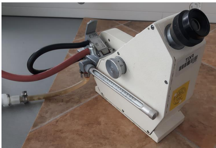
Slika 3.3. Abbeov refraktometar RL3, PZO Varšava
