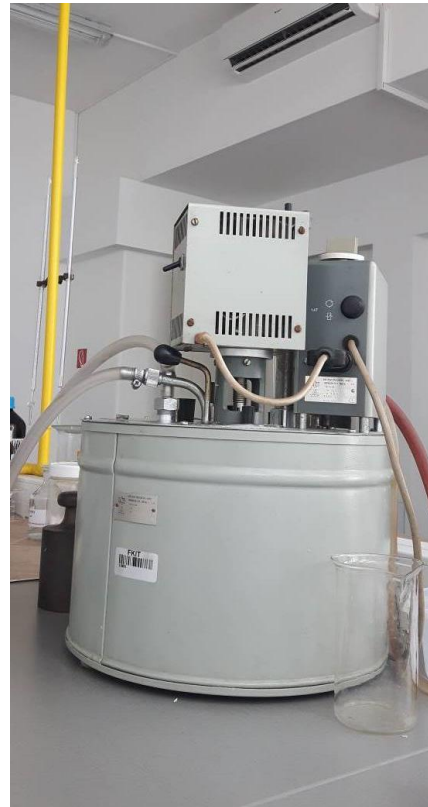
Slika 3.2. Termostatirana zračna kupelj MLW
