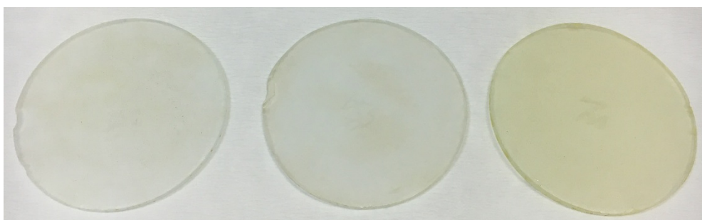
Slika 22. Pločice s imobiliziranim fotokatalizatorom nakon korištenja u 6. ciklusa fotokatalitičke obrade DCF-a, s lijeva na desno – kemijski reaktivirana pločica, toplinski reaktivirana te sušena pločica (bez reaktivacije).
