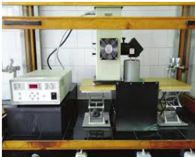
Slika 9. Simulator Sunčevog zračenja.
