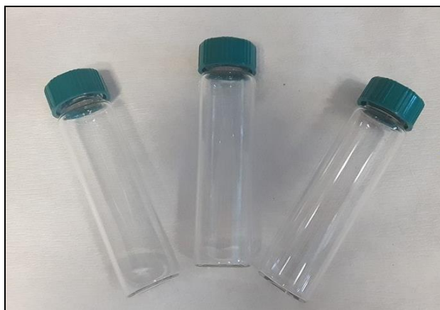
Slika 16. Staklene kivete za uzimanje uzorka za DOC.
