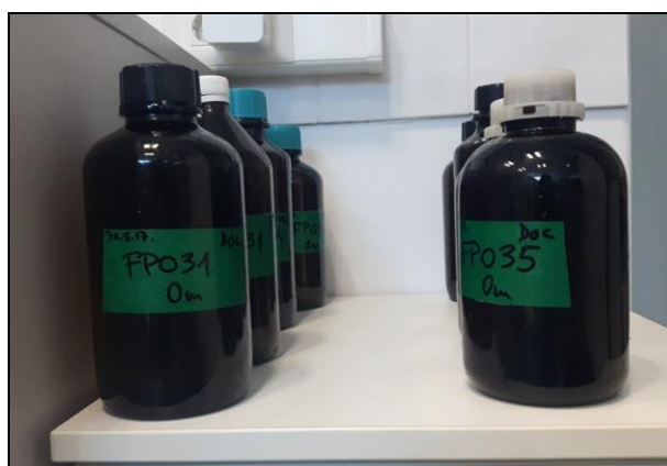
Slika 13. Staklene tamne boce za čuvanje uzoraka volumena 1 dm 3 .
