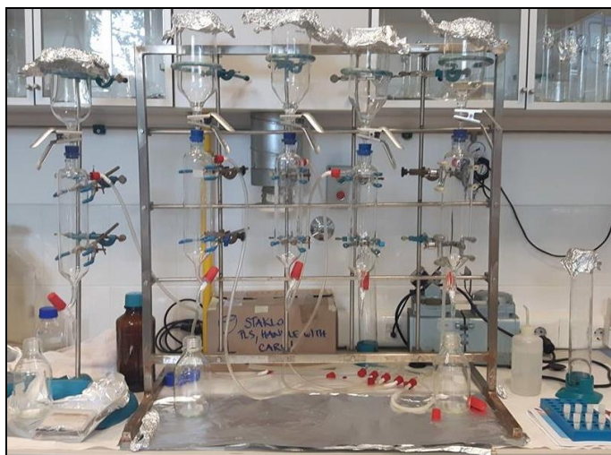
Slika 15. Postolje i aparatura za postupak provedbe filtracije.
