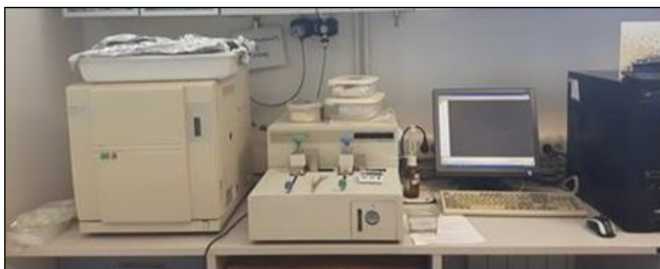
Slika 10. TOC analizator, Shimadzu TOC-V CPH + SSSM-5000A.
