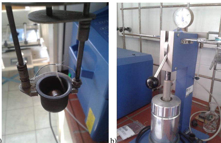
Slika 3.2.8 a) odvaga uzorka u čeliji za zapaljenje, b) kalorimetrijska posuda u postupku punjenja kisikom pod tlakom od 3 bara.
