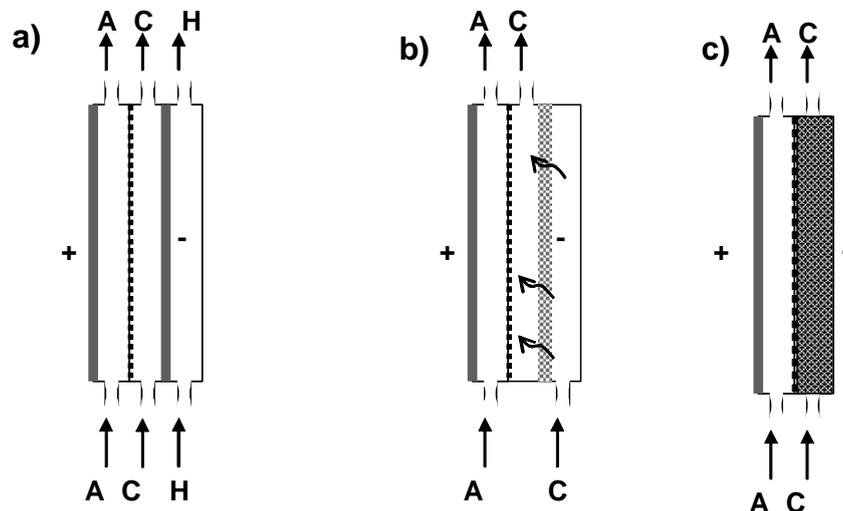
**Slika 2.7.** Različite modifikacije reaktora s paralelnim pločama. a) treći dio u reaktoru služi kao izmjenjivač topline b) ugrađena je trodimenzijska elektroda sa strujanjem elektrolita preko elektrode ("flow through" elektroda) c) ugrađena je trodimenzijska elektroda sa strujanjem kroz elektrodu („flow by“ elektroda)
