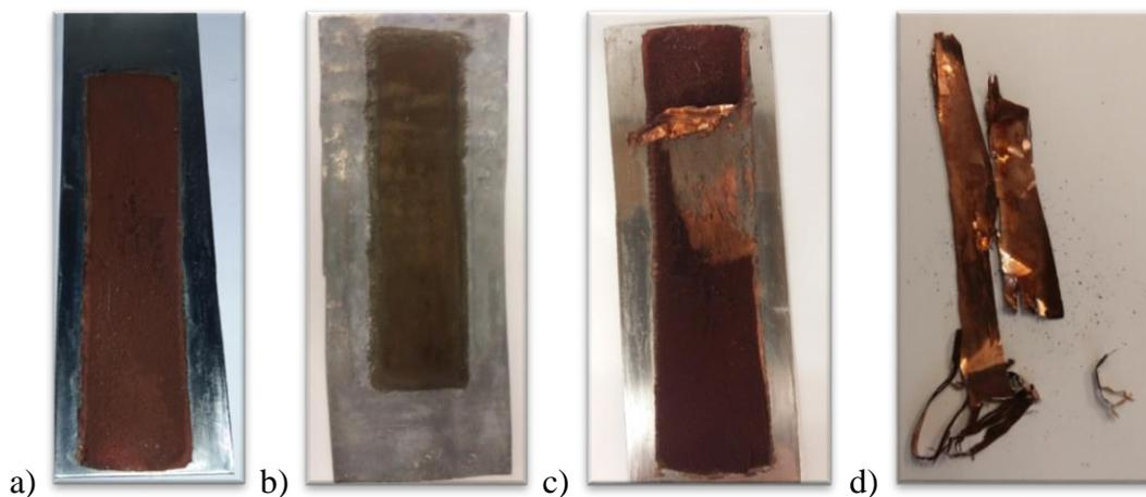
**Slika 3.5.** Prikaz a) čelične elektrode nakon redukcije i b) olovne elektrode nakon polarizacije c) elektroda s koje je djelomično uklonjen bakar, d) izgled reduciranog bakra koji je odvojen od površine elektrode
