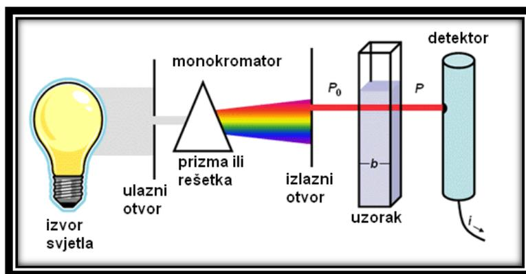
Slika 2.9. Shematski prikaz spektrofotometra <sup>[15]</sup>
