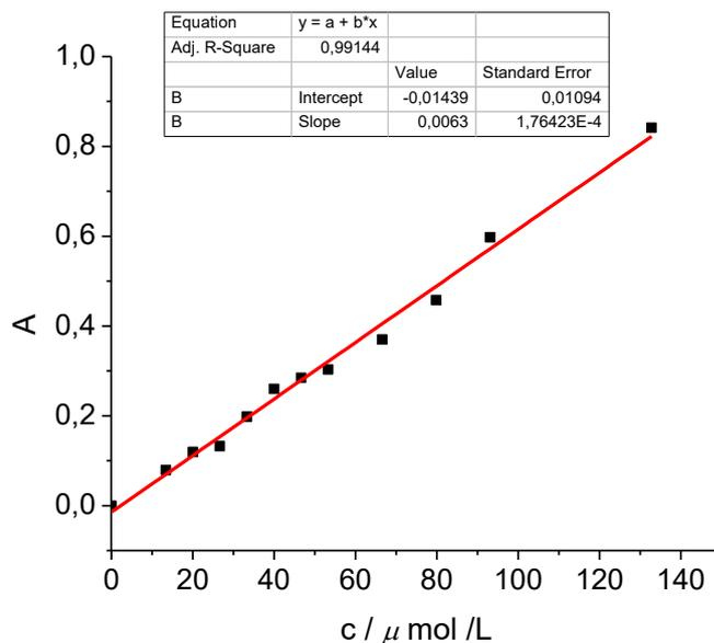
Slika 3.9. Baždarni dijagram za otopinu bakar(II)-sulfata+MTB
