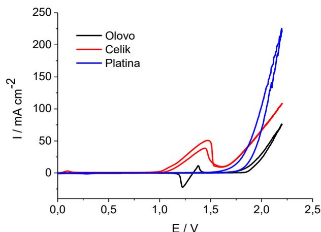
**Slika 5.1.** Usporedba cikličkih voltamograma dobivenih tijekom polarizacije elektroda od raznih materijala u modelnoj otopini CuSO<sub>4</sub>
