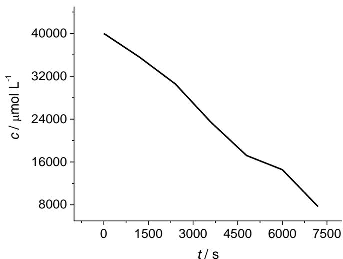
**Slika 4.8.** Grafički prikaz ovisnosti koncentracije dobivenog bakra o vremenu pri naponu od 2,5 V i brzini pumpe 4.
