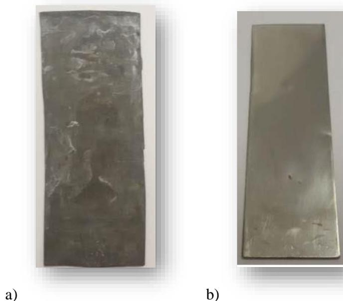
**Slika 3.4.** Prikaz a) olovne i b) čelične elektrode
