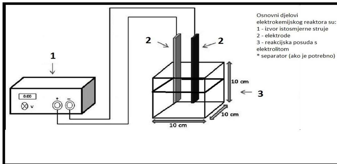
**Slika 2.5.** Prikaz osnovnih dijelova elektrokemijskog reaktora <sup>[11]</sup>
