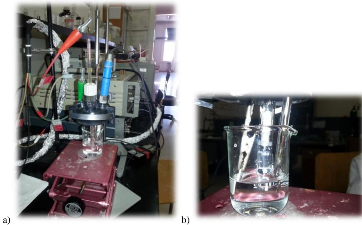
**Slika 3.10.** Prikaz a) aparature za cikličku voltametriju i b) troelektrodnog sustava – radne, referentne i protuelektrode
