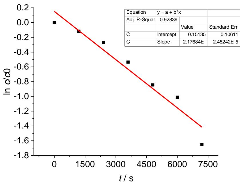
**Slika 4.9.** Grafički prikaz logaritma koncentracije dobivenog bakra u vremenu pri naponu od 2,5 V i brzini pumpe 4. Na slici je prikazan nagib i odsječak na y-osi.
