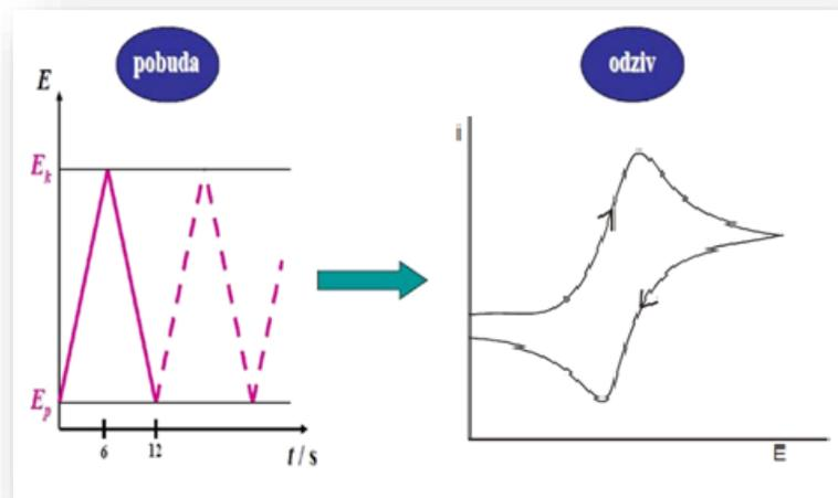
**Slika 2.12.** Prikaz signala pobude i signala odziva u cikličkoj voltametrij
