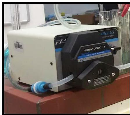
Slika 3.2. Pumpa s podesivom brzinom protoka
