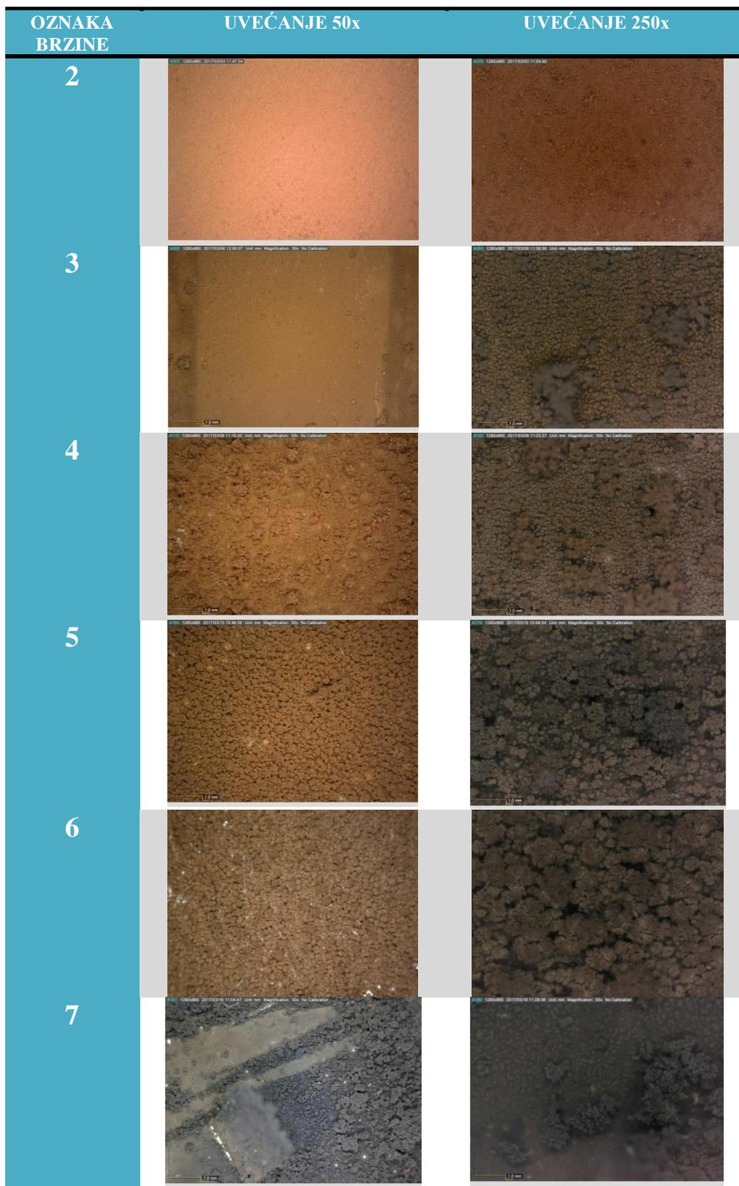
**Slika 5.4.** Prikaz površine bakra zabilježen optičkim mikroskopom za slučajeve kad je bakar taložen uz različite brzine protoka pri naponu od 2,5 V
