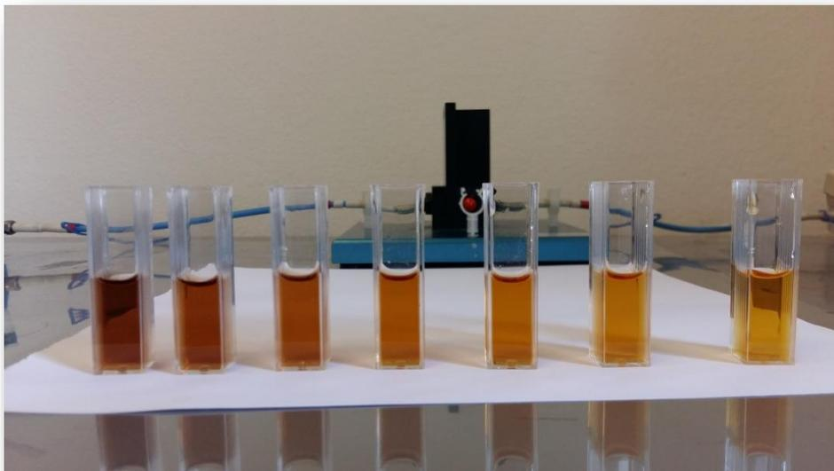
**Slika 3.7.** Priprema uzoraka za određivanje nepoznate koncentracije bakra metodom UV/VIS spektrometrije
