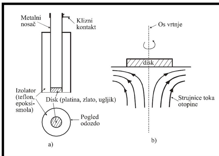
**Slika 2.13.** Shema rotirajuće disk-elektrode s kliznim električnim kontaktom (a) i prikaz strujnica otopine uz rotirajući disk (b).<sup>[19]</sup>
