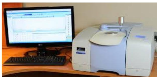
**Slika 9.** Perkin-Elmer Spectrum One FTIR spektrometar
