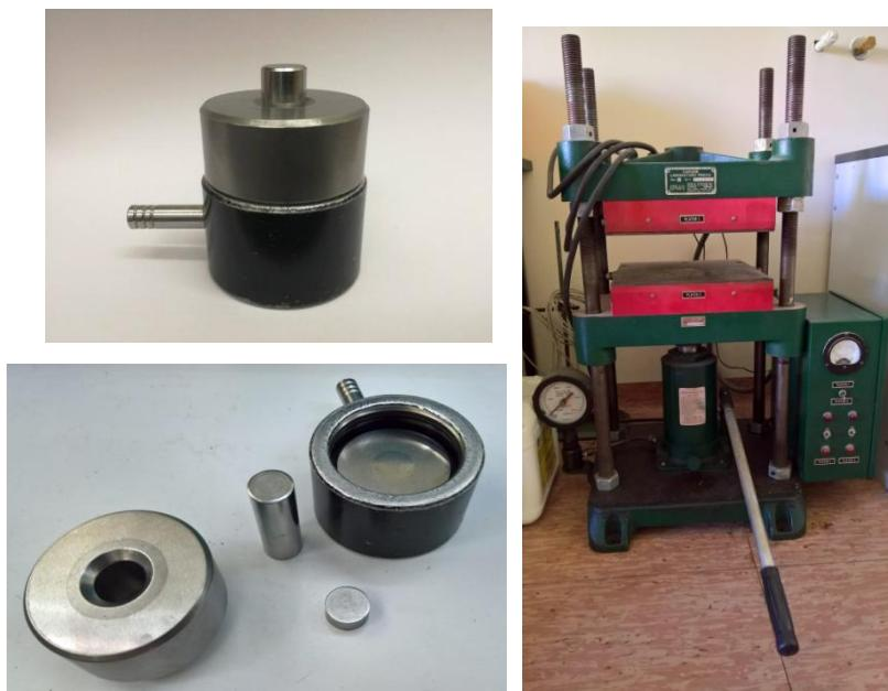
**Slika 11.** Nosač za pastile (lijevo) i Carver Laboratory Press (desno)
