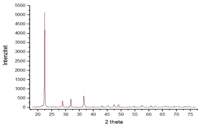
**Slika 17.** Difrakcijska slika uzorka ZrSi100 (čisti SiO<sub>2</sub>)
