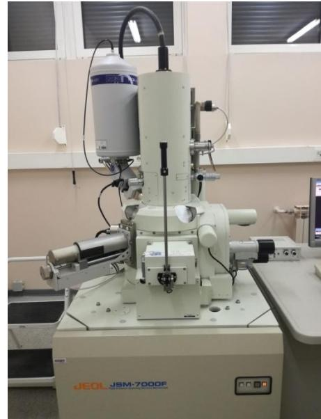
**Slika 14.** Pretražni elektronski miskroskop Joel JSM-7000F
