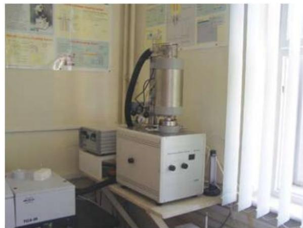
**Slika 13.** Instrument NETZSCH STA 409 [29]
