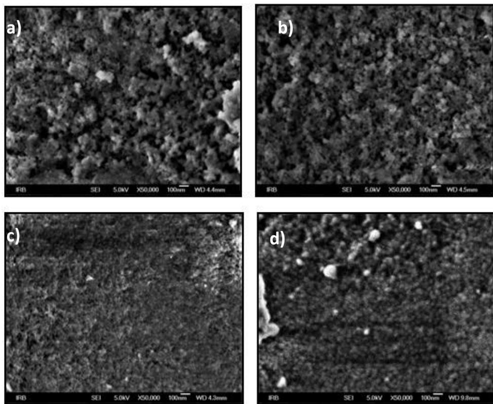
**Slika 47.** Rezultati SEM analize uzorka ZrSi20 žarenog na: a)  $600\text{ }^{\circ}\text{C}$ , b)  $800\text{ }^{\circ}\text{C}$ , c)  $1000\text{ }^{\circ}\text{C}$  i d)  $1200\text{ }^{\circ}\text{C}$  pri različitim uvećanjima
