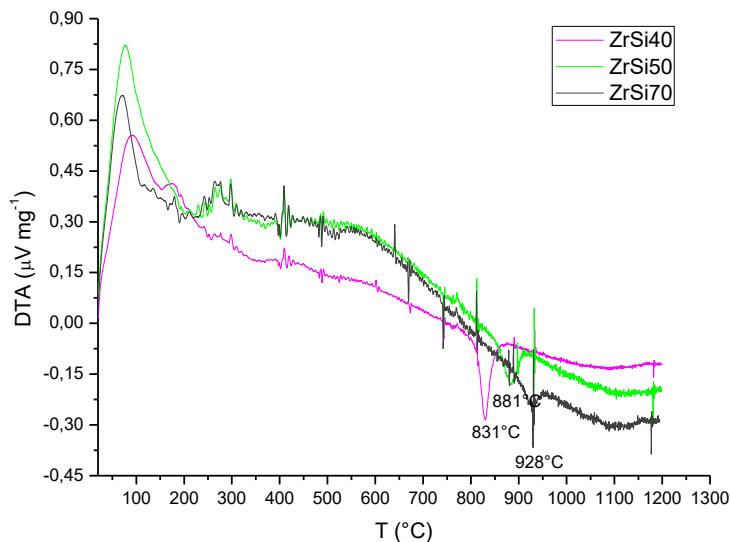
**Slika 41.** DTA krivulja uzorka  $\text{ZrSi40}$ ,  $\text{ZrSi50}$  i  $\text{ZrSi70}$
