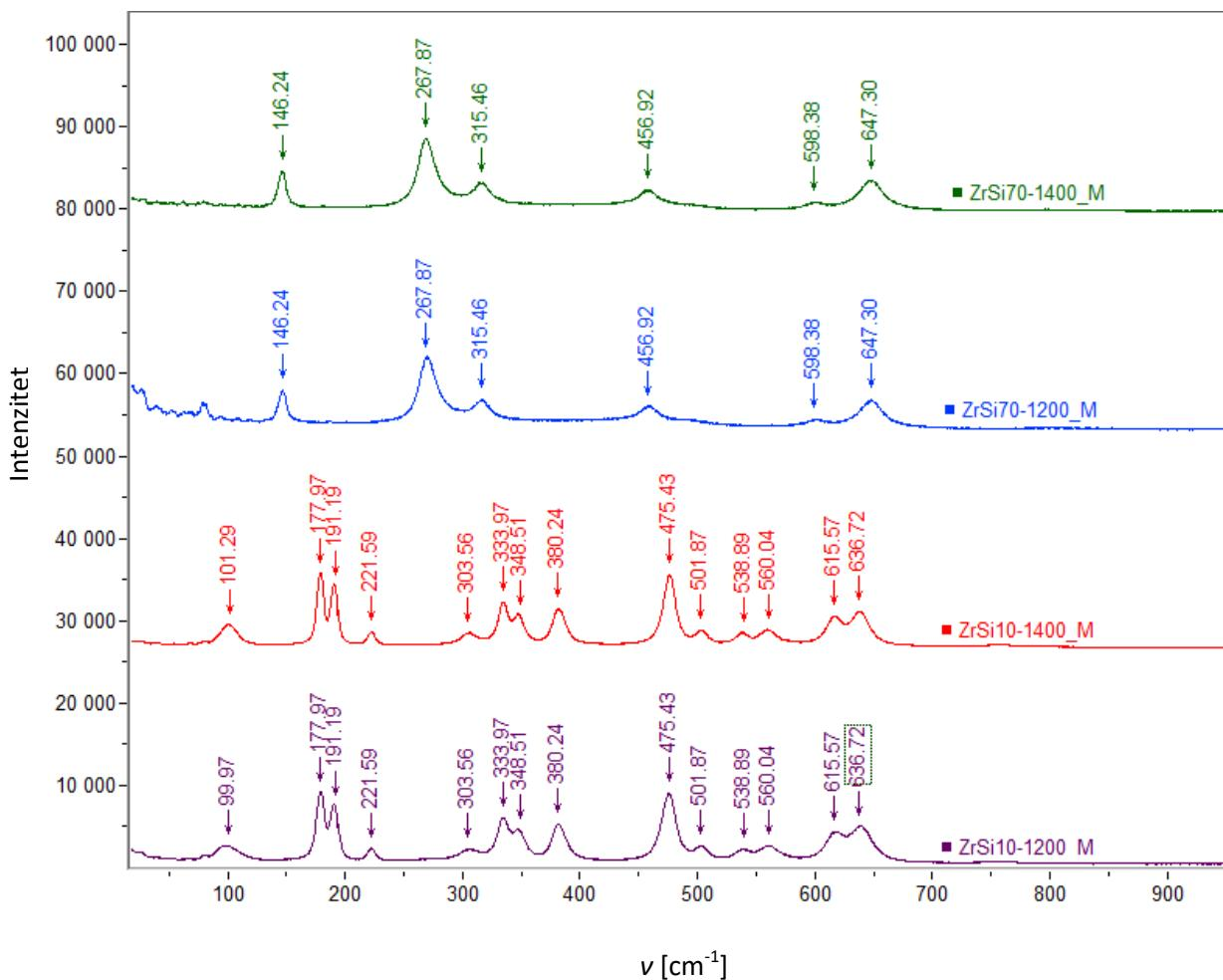
**Slika 39.** Raman spektri uzoraka  $\text{ZrSi}70$  i  $\text{ZrSi}10$  žarenih na  $1200\text{ }^\circ\text{C}$  i  $1400\text{ }^\circ\text{C}$
