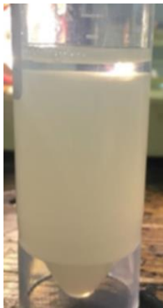
Slika 4.6. Stanje nanosuspenzije CH:EG + Al 2 O 3 nakon 7 dana
