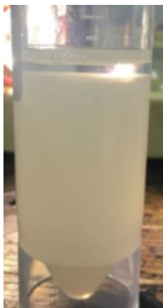
Slika 4.6. Stanje nanosuspenzije CH:EG + Al 2 O 3 nakon 7 dana
