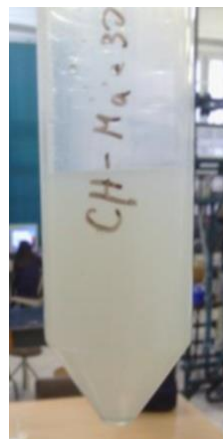
Slika 4.7. Stanje nanosuspenzije CH:MA:30 + Al 2 O 3 nakon 7 dana
