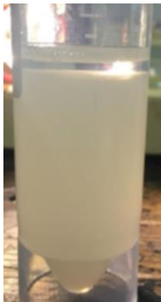
Slika 4.6. Stanje nanosuspenzije CH:EG + Al 2 O 3 nakon 7 dana
