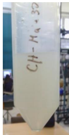
Slika 4.7. Stanje nanosuspenzije CH:MA:30 + Al 2 O 3 nakon 7 dana
