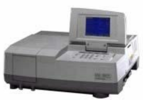
Slika 11. Shimadzu UV-1601 spektrofotometar
