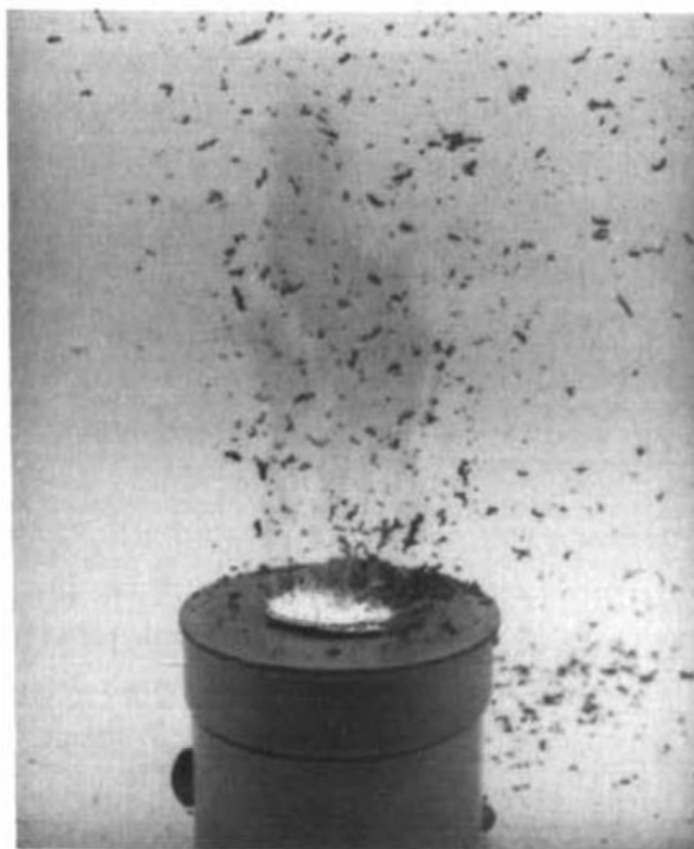
Slika 6. Eksplozivno izgaranje u Pechinijevoj metodi 22
