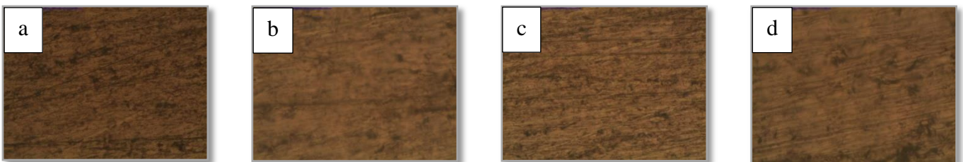
Slika 18. Mikrografije površine aluminijskih pločica tretirane stearinskom kiselinom s prevlakama PCL/ZnO različitog udjela ZnO, dobivene optičkim mikroskopom a) PCL/ZnO - 0 b) PCL/ZnO - 0,003% c) PCL/ZnO - 0,005% i d) PCL/ZnO - 0,01%, povećanje 100x
