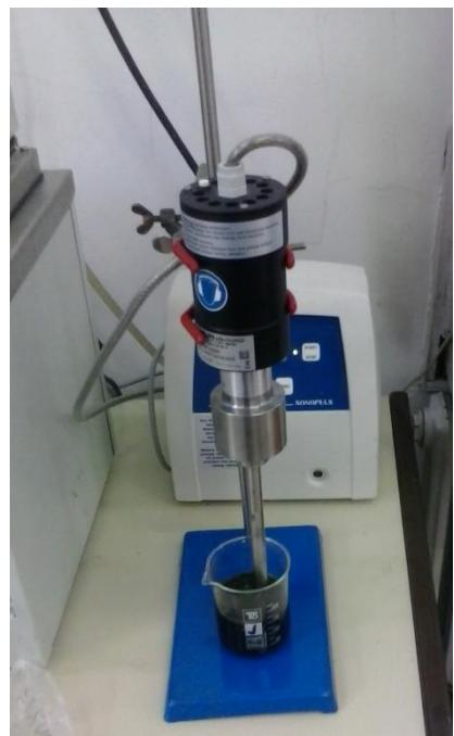
**Slika 22.** Ultrazvučna sonda
