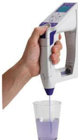
**Slika 26:** Uređaj za mjerjenje gustoće kapljivina - *METTLER TOLEDO Densito 30PX*
