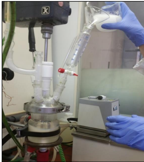
Slika 16. Aparatura korištena za provedbu emulzijske polimerizacije
