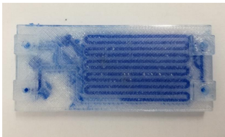
Slika 22. Izrađeni mikroreaktor od materijala Z-Glass na pisaču Zortrax M200, vidljivo prodiranje plavo obojane vode u masu mikroreaktora
