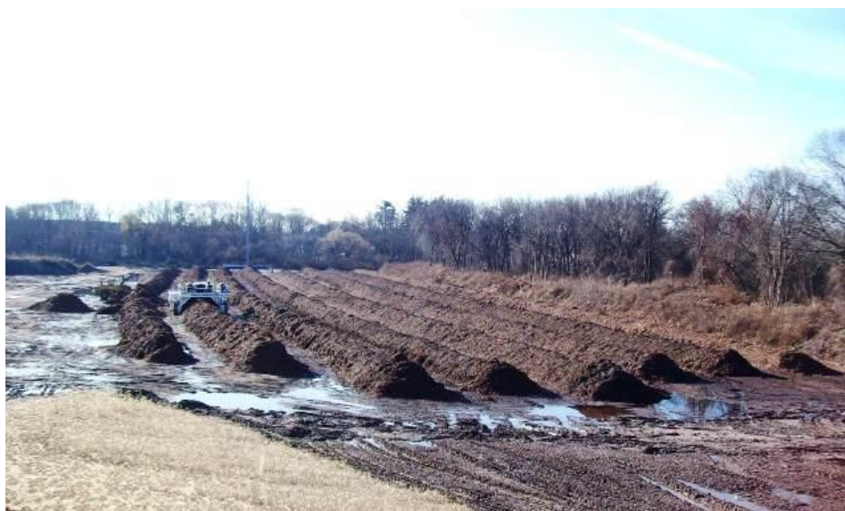
Slika 2.4. Prikaz windrow sustava kompostiranja. 49
