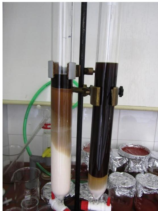
Slika 3.2.18.1. Lijevo se nalazi kolona ( $l = 18 \text{ cm}$ ) nakon dva dana od početka adsorpcije, a desno kolona ( $l = 3 \text{ cm}$ ) fotografirana nakon 45 minuta od početka adsorpcije.
