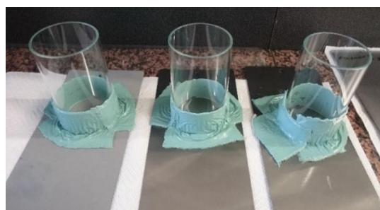
**Slika 15.** Uzorci korišteni za analizu uz pomoć velike čelije
