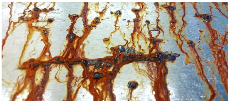
Slika 36. Korozija uzorka 2 nakon 29 dana u slanoj komori
