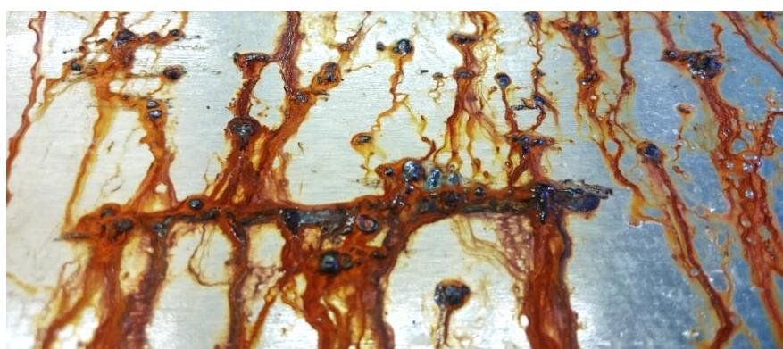
Slika 36. Korozija uzorka 2 nakon 29 dana u slanoj komori
