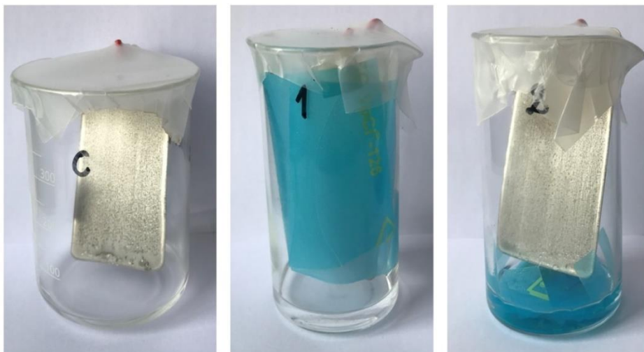
Slika 20. Izlaganje nasoljenih pločica destiliranoj vodi u neinhibiranom sustavu (C), u sustavu s inhibitorom obloženim stijenkama posude (1) i sustavu s otopljenim inhibitorom (2).
