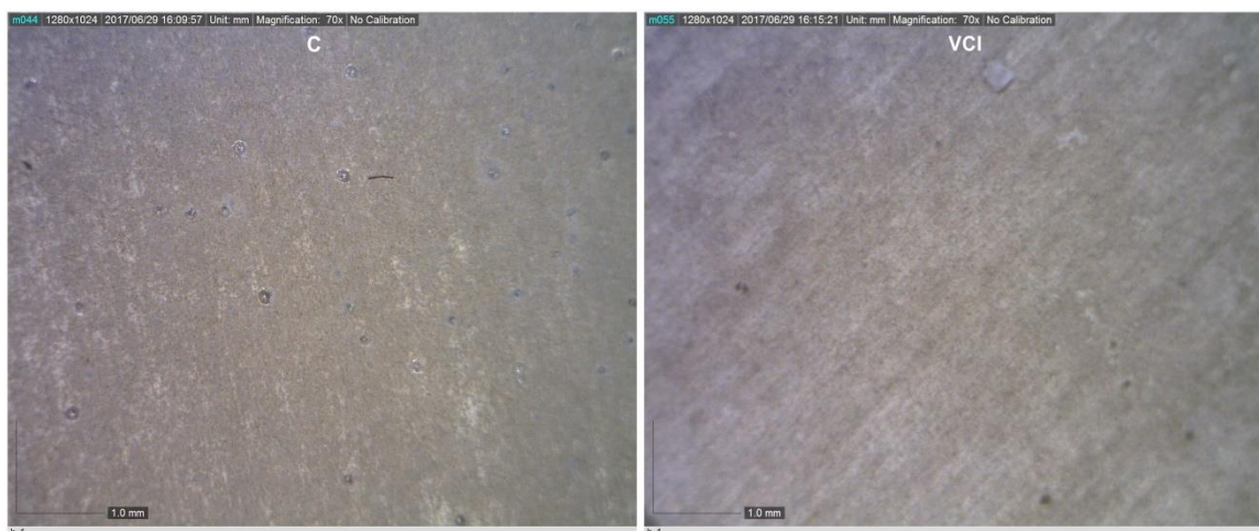
Slika 27. Testne površine nakon 60 dana izlaganja neinhibiranoj i inhibiranoj 3,5% otopini NaCl-a snimljene svjetlosnim mikroskopom pri povećanju 70x.
