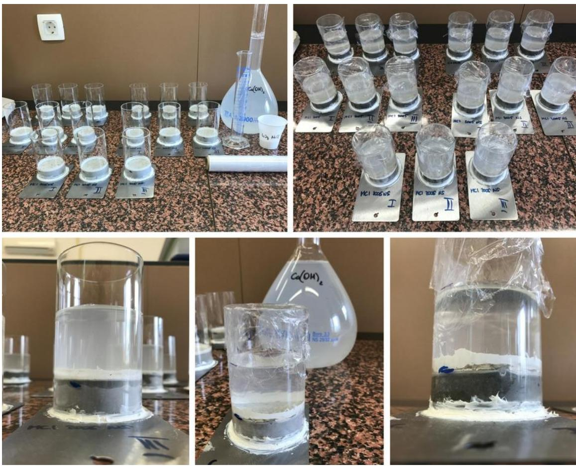
Slika 11. Priprema i dodatak elektrolita u uzorke
