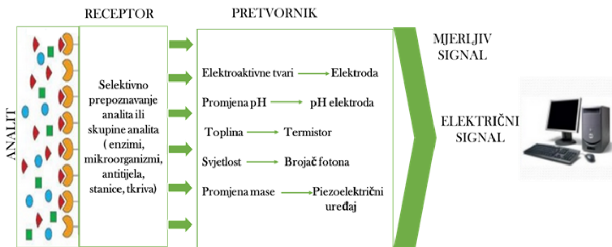
Slika 1. Shematski prikaz senzora.
