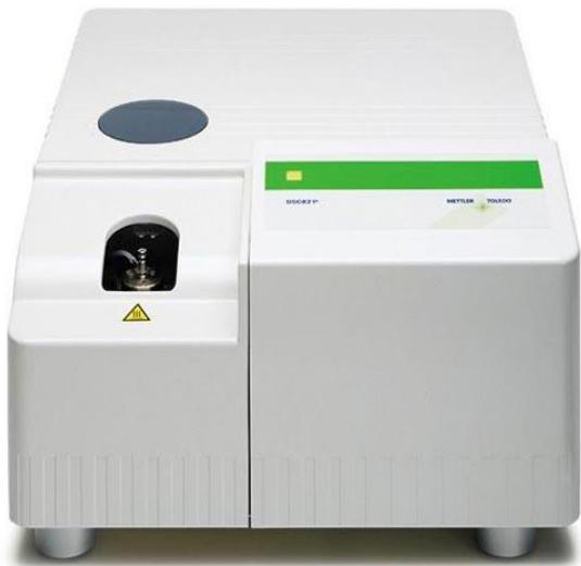
Slika 7. Prikaz Mettler-ToledoDSC 822e kalorimetra.
