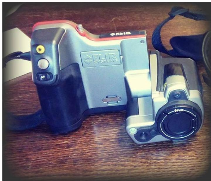
Slika 17. FLIR T360 infracrvena kamera.
