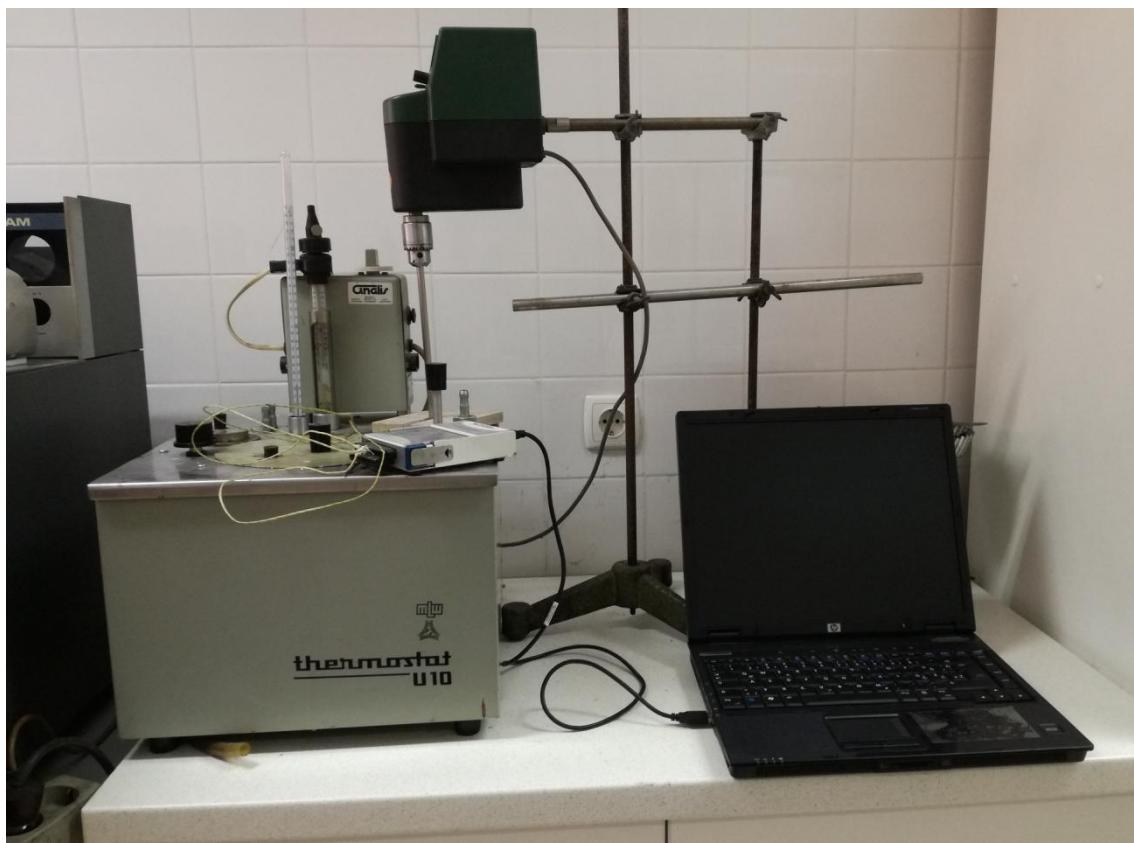
Slika 10. Fotografija korištenog sustava za mjerjenje temperature u centru kalupa. Sustav se sastoji od temostata (prikazan uljni temostat), termopara i osobnog računala.
