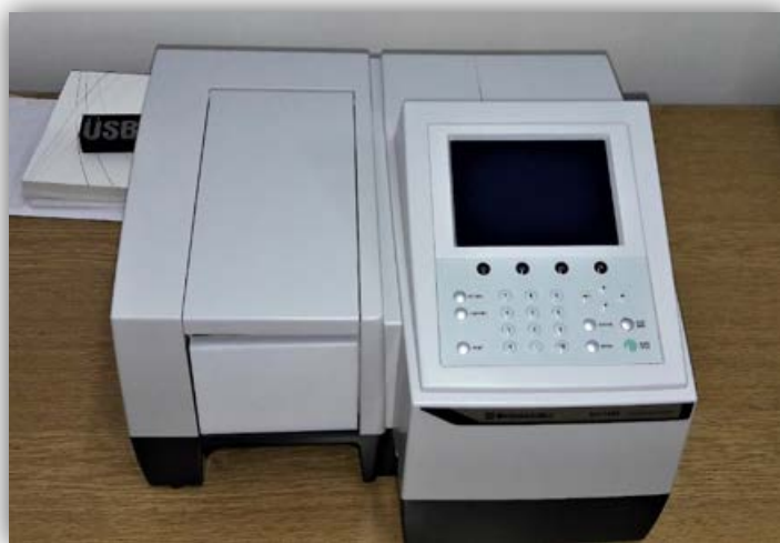
Slika 3.9. Fotografija spektrofotometra UV-1280 (Shimadzu, Kyoto, Japan).
