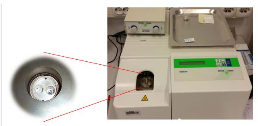
Slika 3.4. Fotografija diferencijalnog pretražnog kalorimetra (Zavod za inženjerstvo površina polimernih materijala, FKIT).
