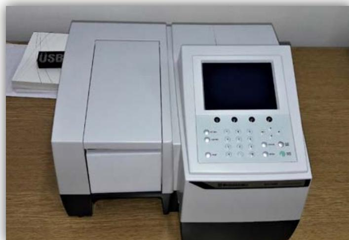
**Slika 3.9.** Fotografija spektrofotometra UV-1280 (Shimadzu, Kyoto, Japan).
