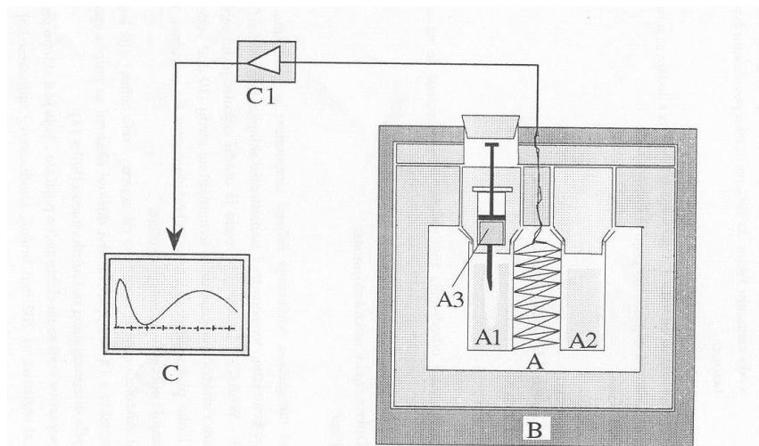
**Slika 6.** Pojednostavljeni prikaz aparature za određivanje topline hidratacije pomoću diferencijalnog mikrokalorimetra. A – diferencijalni mikrokalorimetar, B – termostat, C – računalno, A1 – mjerna ćelija, A2 – referentna ćelija, A3 – medicinska šprica s vodom, C1 – električni uređaj za prikupljanje signala termoparova
