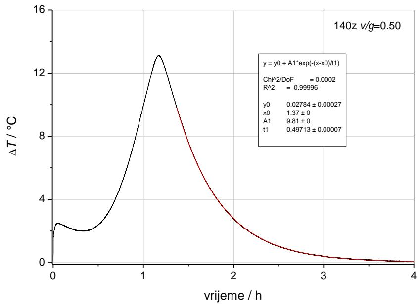
**Slika 32.** Rezultati mjerjenja temperature uzorka pripravljenog na 140°C zatvorenog sustava tijekom hidratacije u kalorimetru
