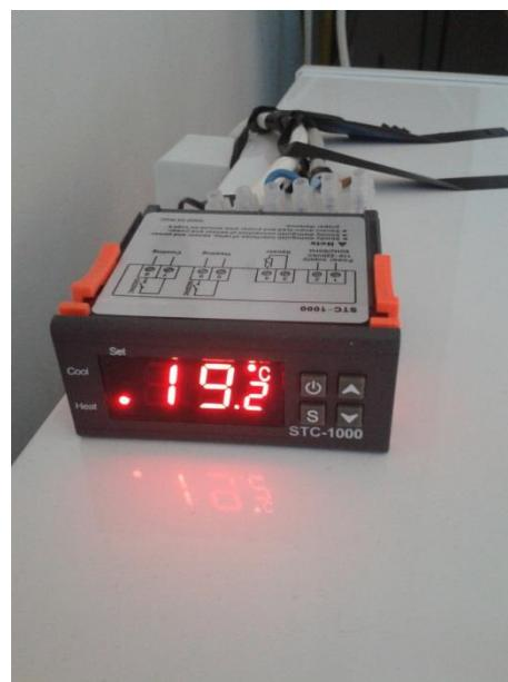
**Slika 9.** Termostat za regulaciju temperature u škrinji
