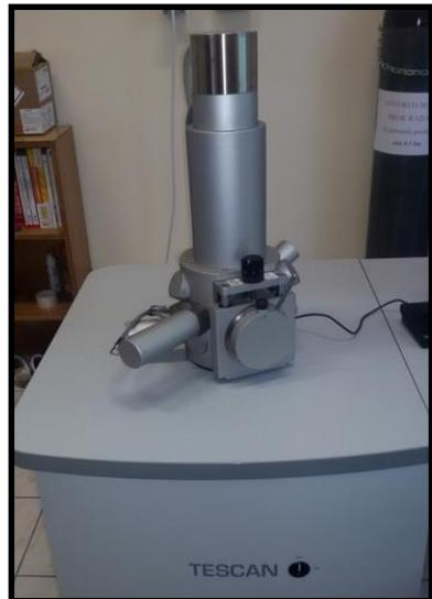
**Slika 18.** Elektronski mikroskop SEM-TESCAN VEGA TS5236LS
