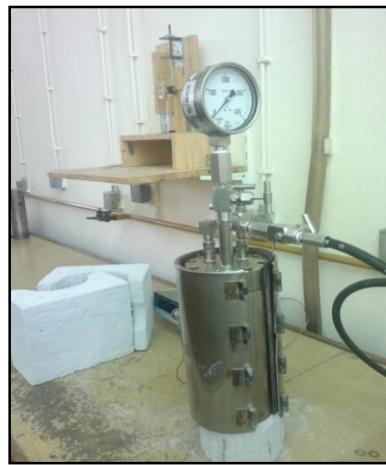
Slika 15. Hidrotermalni reaktor
