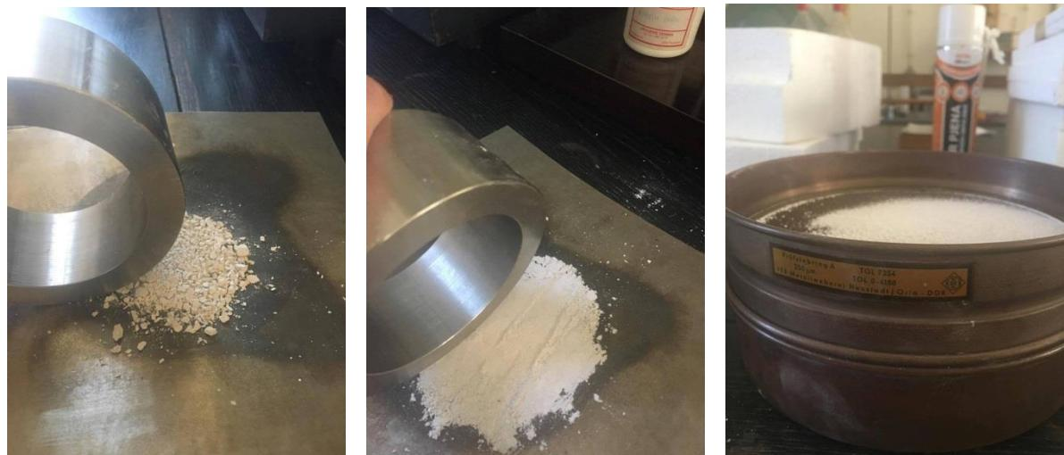
**Slika 16.** Ručno drobljenje uzorka te prosijavanje
