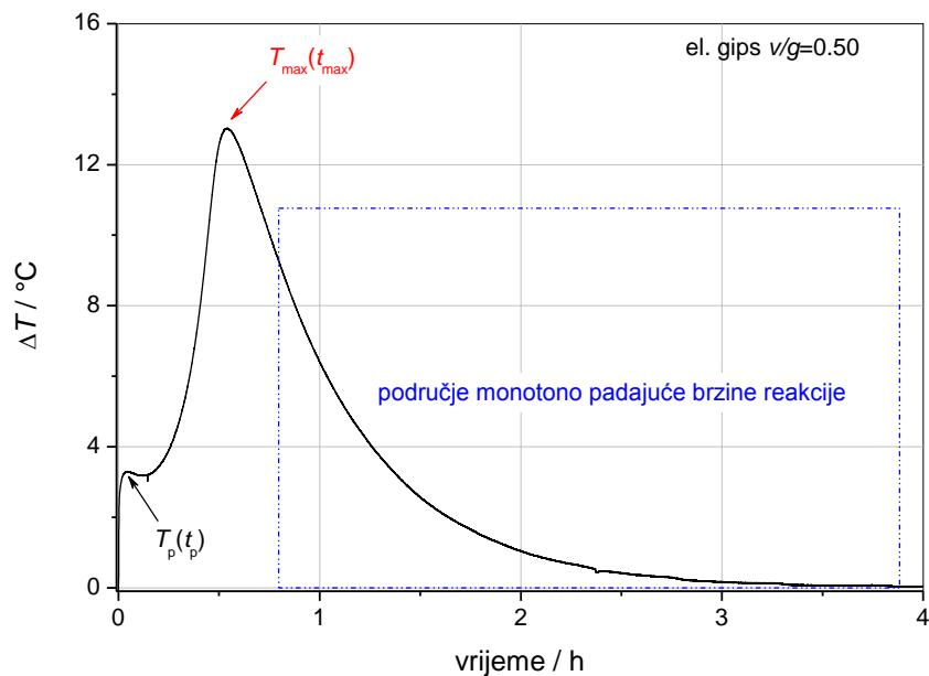
**Slika 29.** Rezultati mjerjenja temperature uzorka komercijalnog električarskog gipsa tijekom hidratacije u kalorimetru
