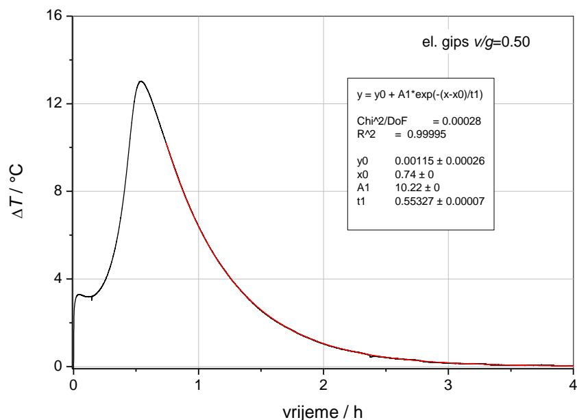
**Slika 30.** Rezultati mjerjenja temperature uzorka komercijalnog električarskog gipsa tijekom hidratacije u kalorimetru
