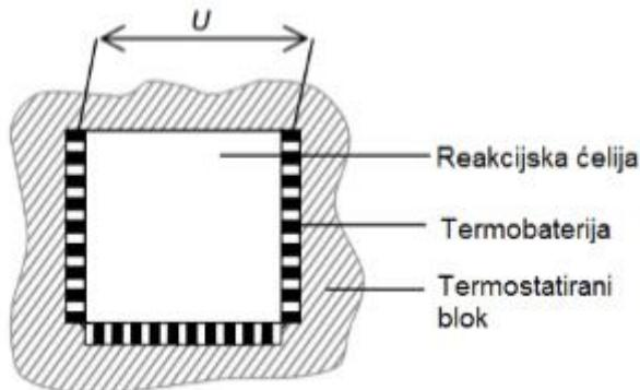
**Slika 4.** Shematski prikaz principa rada izotermnog konduksijskog kalorimetra
