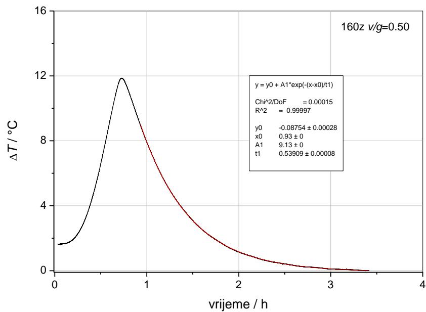
**Slika 2.** Rezultati mjerjenja temperature uzorka pripravljenog na 160°C zatvorenog sustava tijekom hidratacije u kalorimetru
