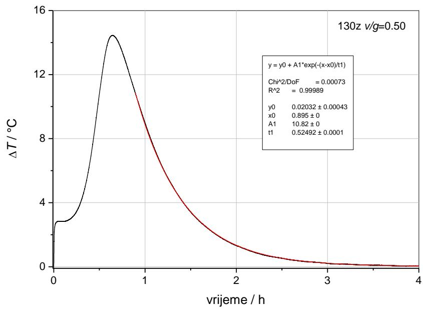
**Slika 31.** Rezultati mjerjenja temperature uzorka pripravljenog na 130°C zatvorenog sustava tijekom hidratacije u kalorimetru
