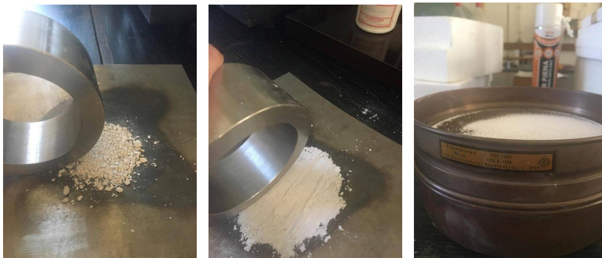
Slika 16. Ručno drobljenje uzoraka te prosijavanje
