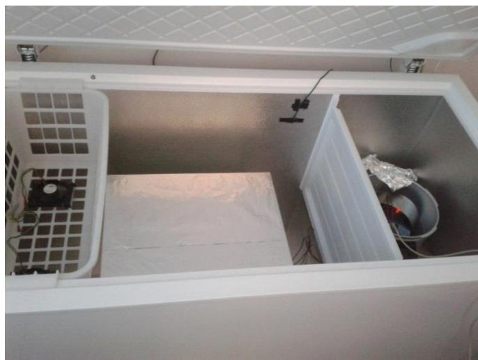
**Slika 13.** Aparatura za mjerjenje oslobođene topline prilikom hidratacije
