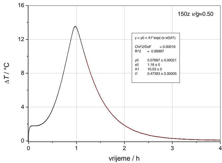
**Slika 33.** Rezultati mjerjenja temperature uzorka pripravljenog na 150°C zatvorenog sustava tijekom hidratacije u kalorimetru
