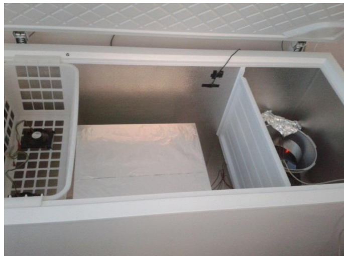
Slika 13. Aparatura za mjerenje oslobođene topline prilikom hidratacije
