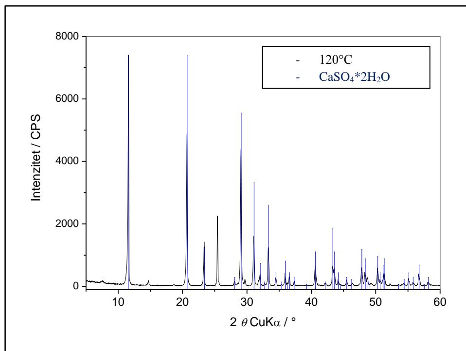
**Slika 21.** Rezultati rendgenske difrakcijske analize – otpadni gips,  $120^\circ\text{C}$  (zatvoren sustav)
