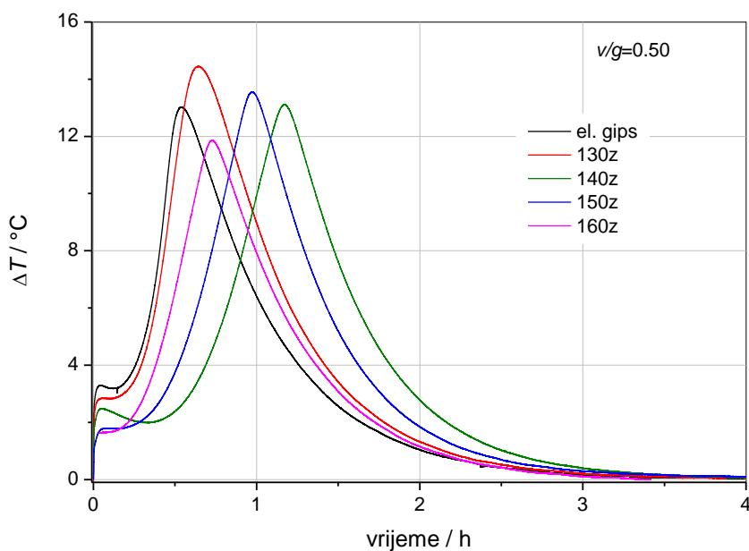
**Slika 28.** Rezultati mjerena temperature u razvijenom kalorimetru za uzorce pripravljene hidrotermalnom obradom pri temperaturama 130-160 °C te za uzorak komercijalnog električarskog gipsa.
