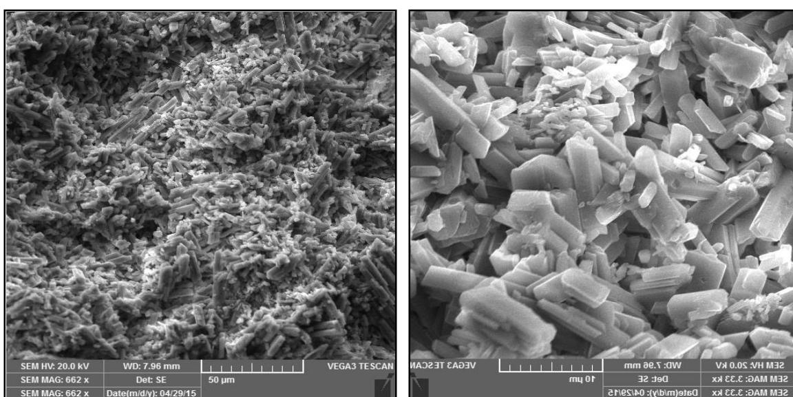
Slika 27. Rezultati elektronske mikroskopije uzorka otpadnog gipsa, 130 °C, zatvoren sustav
