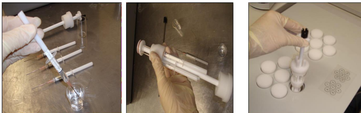
Slika 5. a) Šprica MC CAL b) Sastavljanje pojedinačnih dijelova c) Umetanje MC CAL u mjerni kanal
