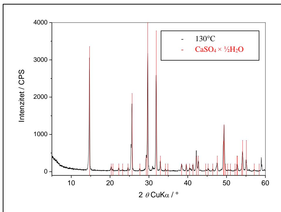
**Slika 22.** Rezultati rendgenske difrakcijske analize – otpadni gips,  $130^\circ\text{C}$  (zatvoren sustav)
