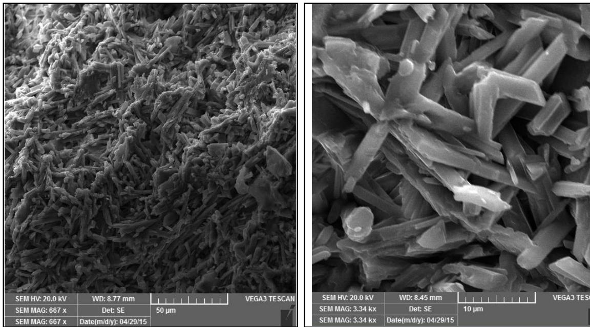
Slika 26. Rezultati elektronske mikroskopije uzorka početne sirovine gdje su vidljivi kristali dihidrata ( $\text{CaSO}_4 \times 2\text{H}_2\text{O}$ ) odgovorni za dobra mehanička svojstva gipsanih kalupa
