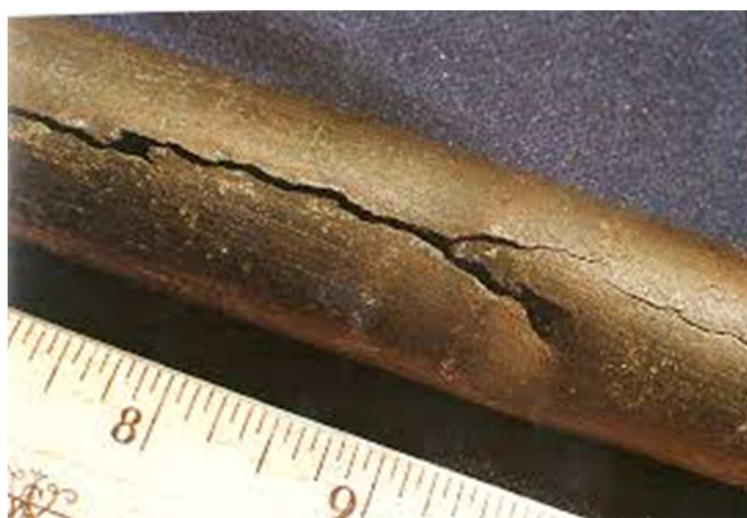
Slika 2.12. Primjer korozijskog raspucavanja uz naprezanje
