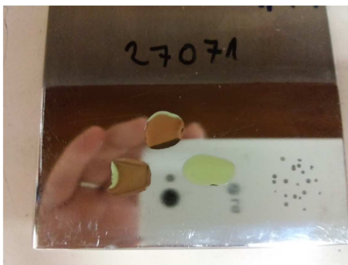
Slika 5.5. Uzorak 27071 površinske hrapavosti R_a=0,06 \mu\text{m} ( \Delta R_a= -0,07\mu\text{m} ) i polarizacijskog otpora R_p= 5800 \text{ k}\Omega \text{ cm}^2
