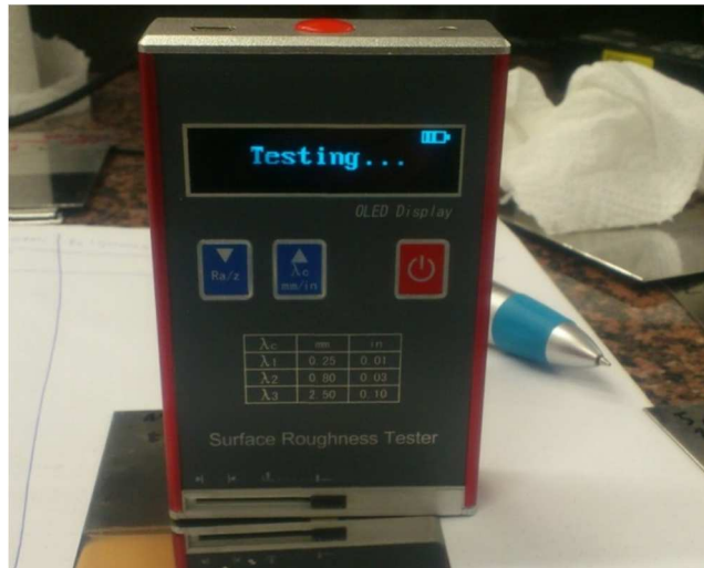
Slika 3.10. Mjerenje površinske hrapavosti
