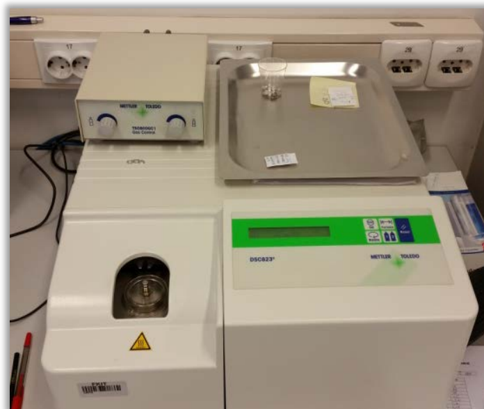
Slika 11. Fotografija diferencijalnog pretražnog kalorimetra (Zavod za inženjerstvo površina polimernih materijala, FKIT).
