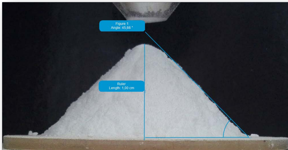
Slika 19. Fotografija formiranog stošca za inicijalni manitol; primjena KLONK Image Measurement softverskog paketa u određivanju nasipnog kuta.
