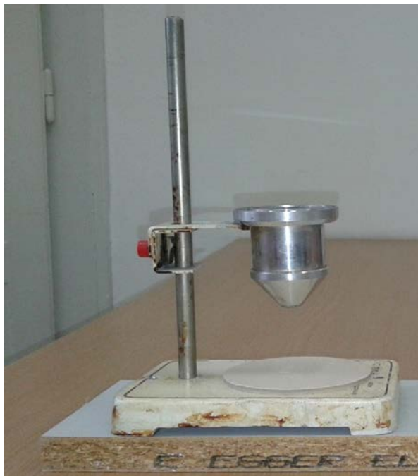
Slika 13. Fotografija lijevka za određivanje nasipnog kuta.
