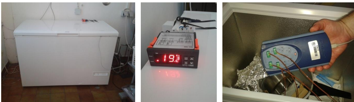
Slika 21. Škrinja za zamrzavanje (lijevo), termostat za regulaciju temperature (sredina), uređaj za prikupljanje podataka (desno)
