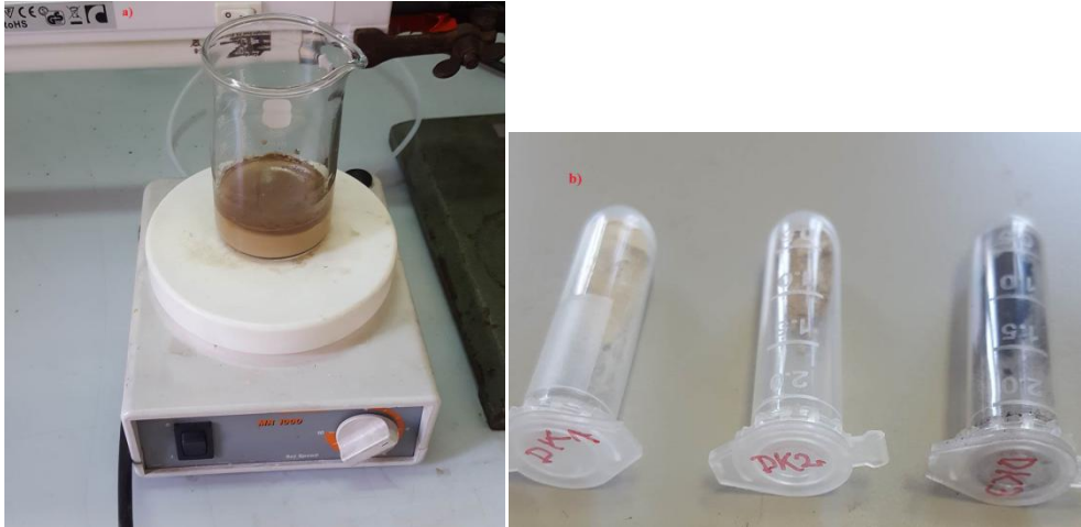
Slika 11. a) Sinteza DK3 uzorka, b) Uzorci dobiveni metodom koprecipitacije
