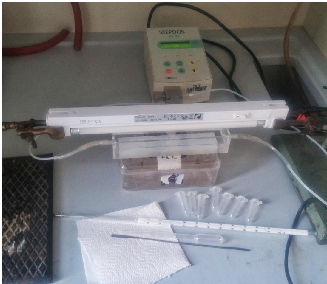
Slika 13. Aparatura za provedbu određivanja fotokatalitičke aktivnosti ZnO sa sunčevom lampom
