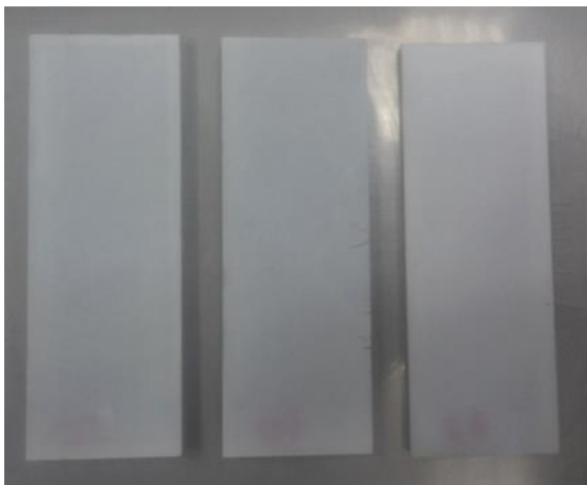
Slika 10. Prevlake cinkovog oksida na predmetnim stakalcima
