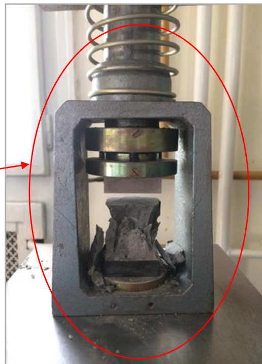
Slika 20. Adapter za prihvat uzoraka
