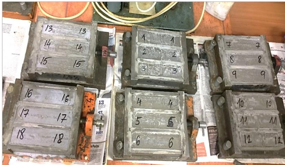
Slika 35. Kalupi s različitim koncentracijama usporivača
