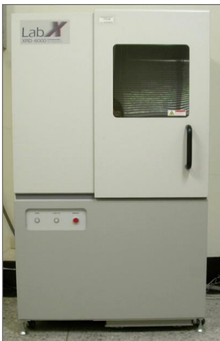
Slika 17. XRD difraktometar Shimadzu D600
