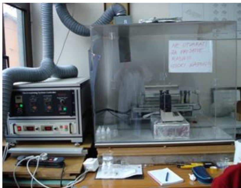
Slika 12. Uređaj za elektroispredanje na Tekstilno-tehnološkom fakultetu u Zagrebu.
