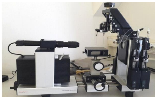
Slika 15. Goniometar, DataPhysics OCA 20 Instrument
