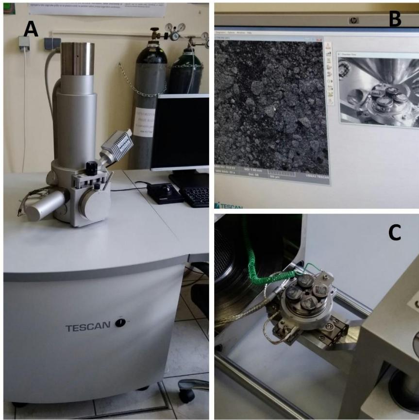
*Slika 13. A) Tescan Vega 3 pretražni elektronski mikroskop
