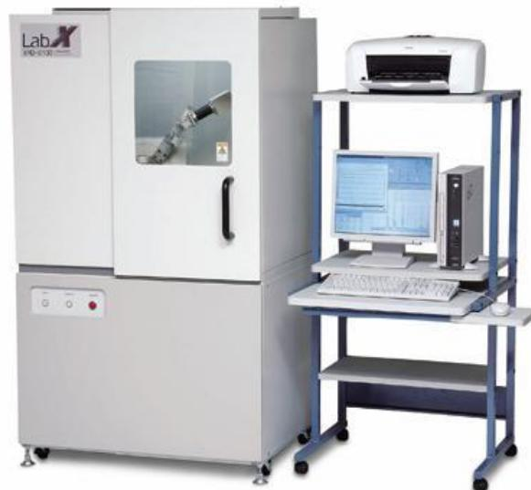
Slika 11. Shimadzu XRD 6000 difraktometar
