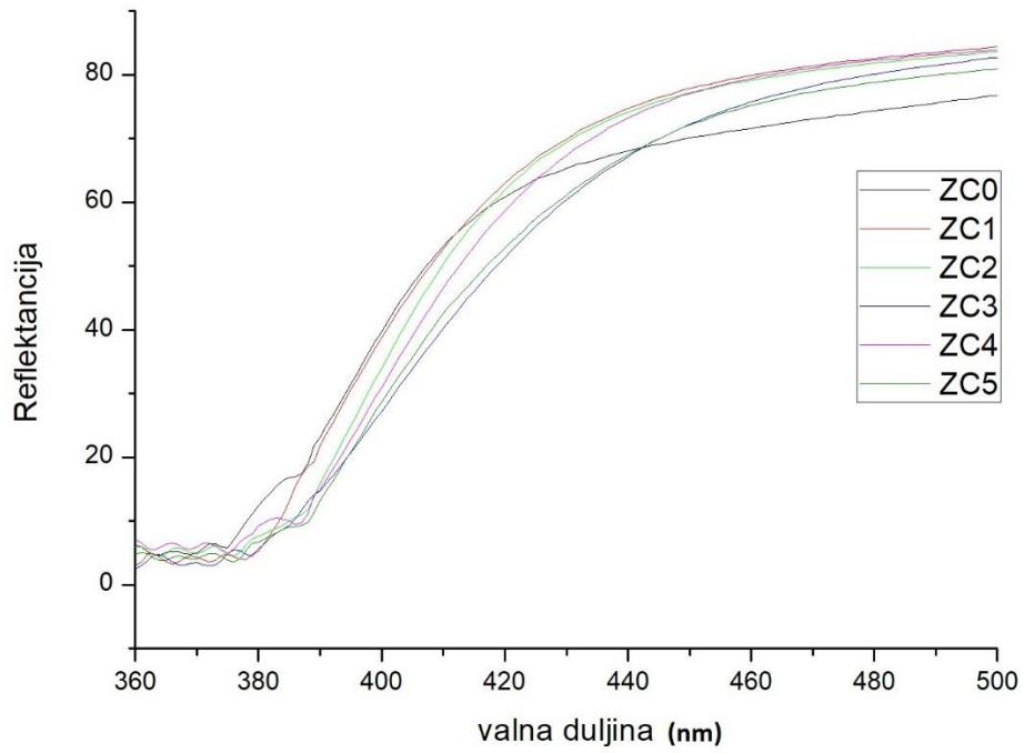
Slika 24. UV-Vis DRS spektar uzoraka dobivenih mehanokemijskom sintezom
