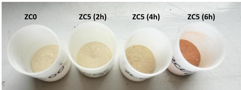
Slika 19. Razlika boja uzoraka ovisno o vremenu sinteze
