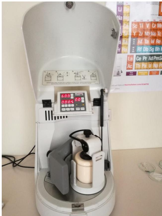
Slika 10. Planetarni mlin Frisch Pulverisette 6
