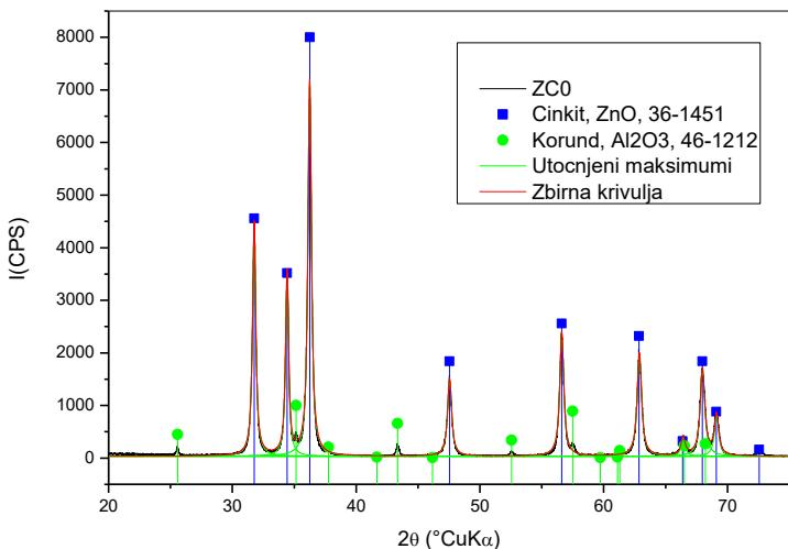
Slika 21. Difraktogram za nedopirani uzorak s utočnjjenim maksimumima za određivanje parametara jedinične čelije i veličine kristalita
