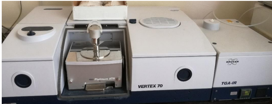
Slika 12. FTIR Bruker Vertex 70
