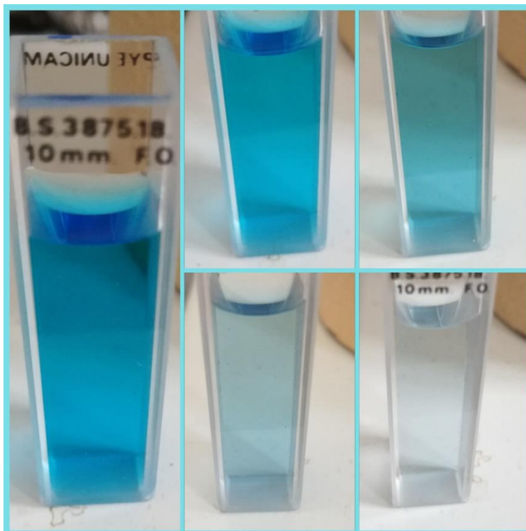
Slika 31. Obezbojenje uzoraka tijekom fotokatalize
