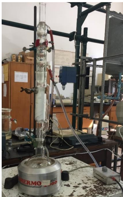
Slika 15. Soxhlet ekstraktor iz laboratorija korišten za oduljivanje
