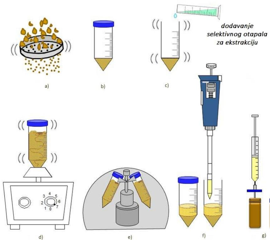
Slika 8. Stupnjeviti prikaz procesa izluživanja (a) prosijavanje; b) doziranje i priprema za dodavanje selektivnog otapala; c) dodavanje selektivnog otapala za ekstrakciju; d) miješanje otapala i krutine; e) centrifugiranje po potrebi radi bolje separacije faza; f) uzorkovanje tekuće faze za ispitivanje; g) priprema uzorka za snimanje) [https://www.researchgate.net]
