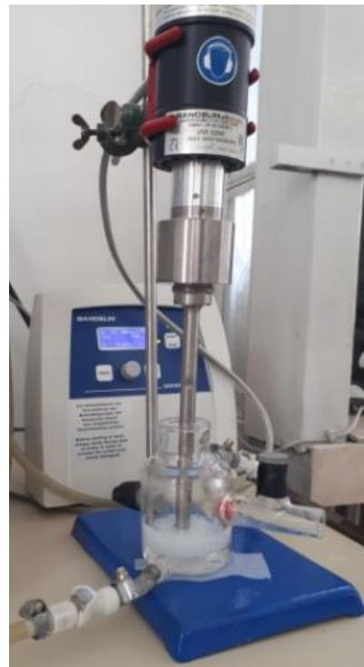
Slika 10. Raspršivanje nanočestica sa ultrazvučnom sondom
