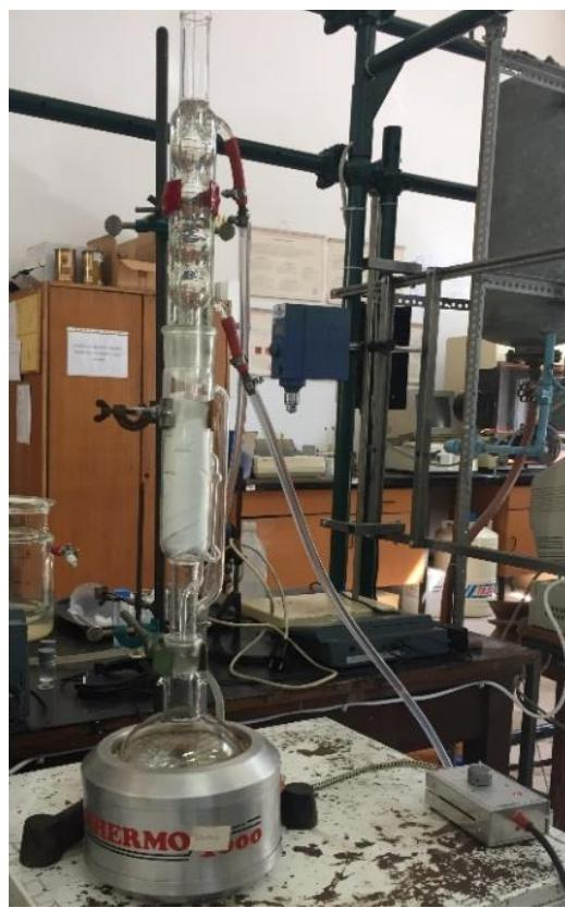
Slika 15. Soxhlet ekstraktor iz laboratorijskog korištenja za oduljivanje
