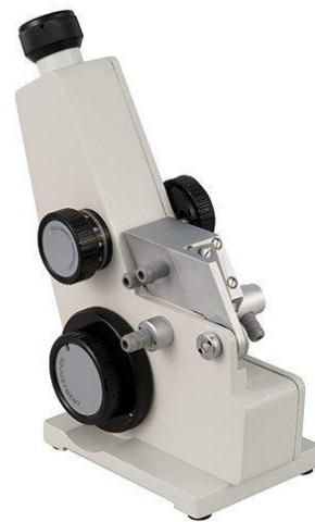
**Slika 3.** Abbeov refraktometar
