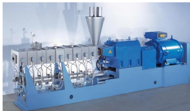
Slika 11. Prikaz pužnog (vijčanog) ekstrudera
