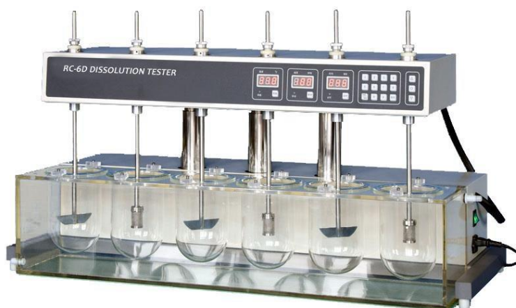
Slika 25. Uređaj za ispitivanje oslobađanja djelatnih tvari (RC-6D, Zhengzhou Nanbei Instrument)
