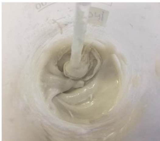
Slika 19. Mješavina rastaljenog PEG-a i DNR-a
