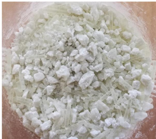
Slika 20. Čvrsta disperzija pomiješana s PVA-filamentom
