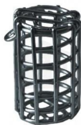
Slika 26. Košarica za potapanje tablete; fotografija i dimenzije
