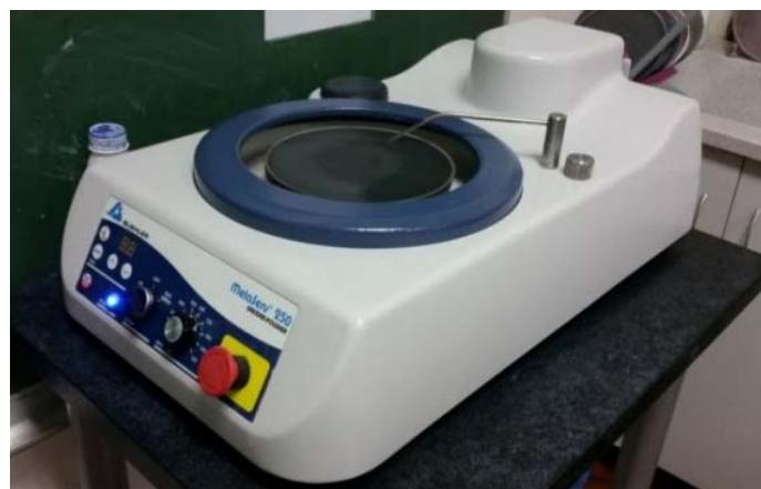
**Slika 15.** Uredaj za poliranje Buehler Meta Serv 250 Grinder - Polisher
