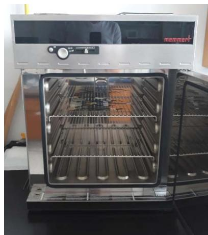
**Slika 17. Peć za sušenje**
