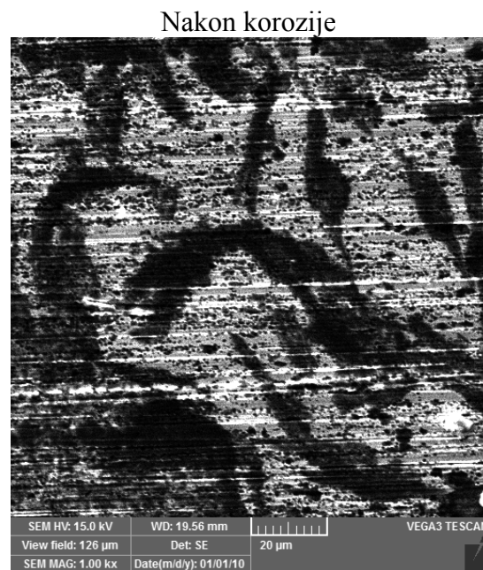
Slika 73. Površina uzorka CuNi 2500 sa debelim filmom
