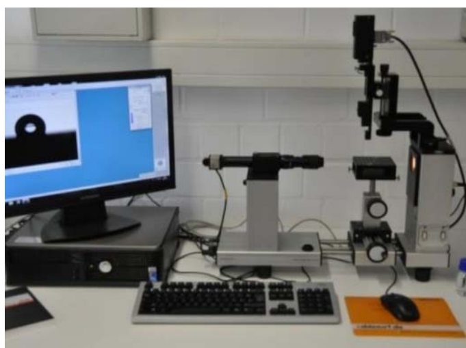
Slika 21. Goniometrar DataPhysics Contant Angle System OCA 20
