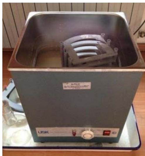
**Slika 16.** Ultrazvučna kupelj
