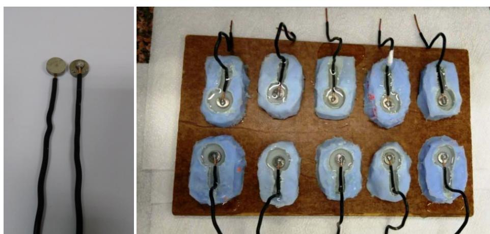
**Slika 14. Priprema radnih elektroda**
