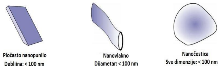
Slika 8. Vrste nanopunila: 1) pločasto punilo, 2) nanovlakno, 3) nanočestica
