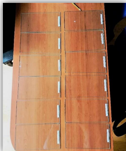
Slika 16. a) Uređaj za izvlačenje filmova b) Filmovi PAK, PAK+TiO 2 i PAK+SiO 2
