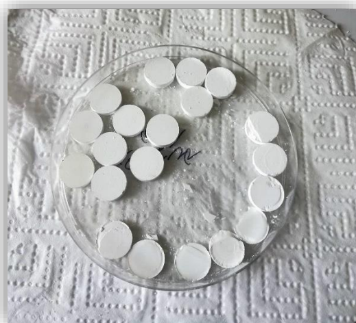
Slika 19. Pastile TiO 2 punila pripravljene prešanjem u kalupu
