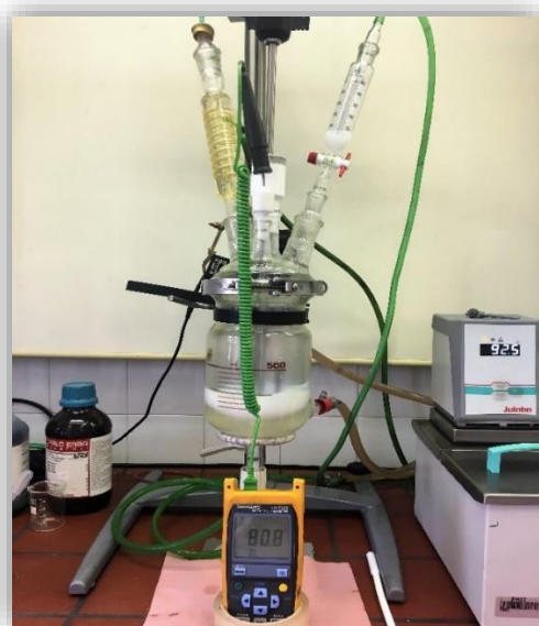
Slika 14. Aparatura za emulzijsku polimerizaciju
