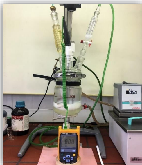
Slika 14. Aparatura za emulzijsku polimerizaciju
