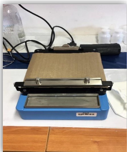
Slika 16. a) Uređaj za izvlačenje filmova b) Filmovi PAK, PAK+TiO 2 i PAK+SiO 2
