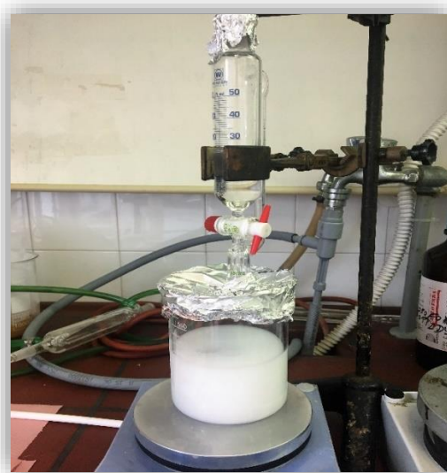
Slika 13. Priprema predemulzije uz dokapavanje monomera kroz lijevak
