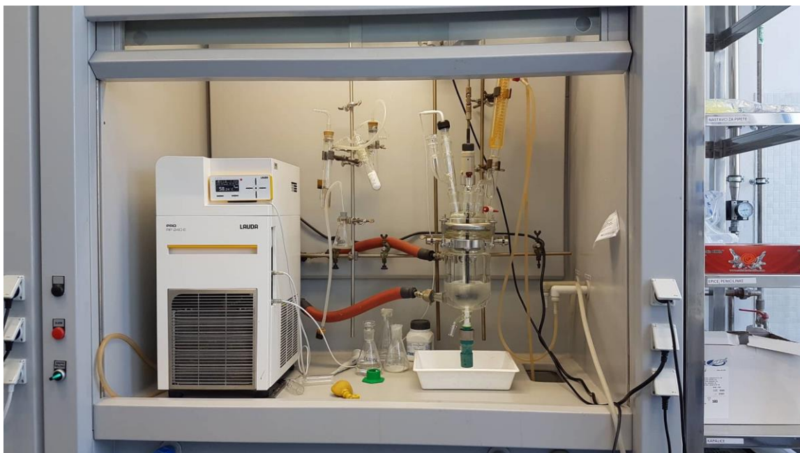
Slika 21. Aparatura za provođenje ekstraktivne destilacije
