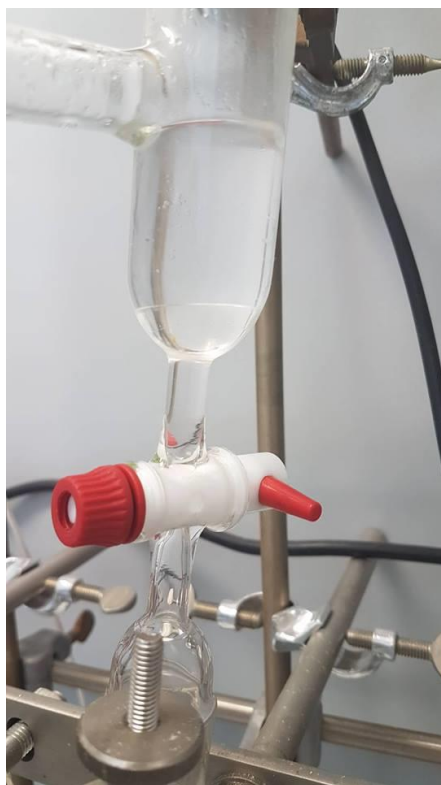
Slika 30. Prikaz raslojavanja 2- metiltetrahidrofurana i vode
