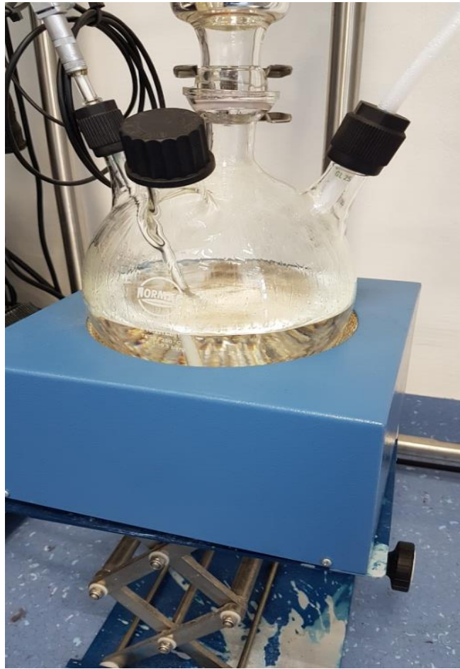
Slika 31. Određivanje koeficijenta prijenosa topline
