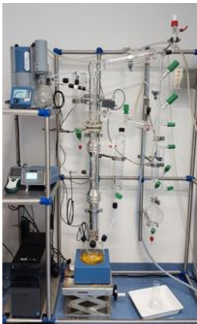
Slika 19. Aparatura za šaržnu destilaciju UNIT DN30/ 2I
