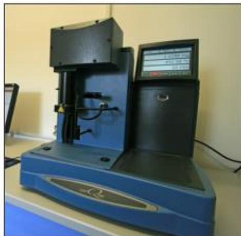
*Slika 22.* Termogravimetar Q500 TA Instruments
