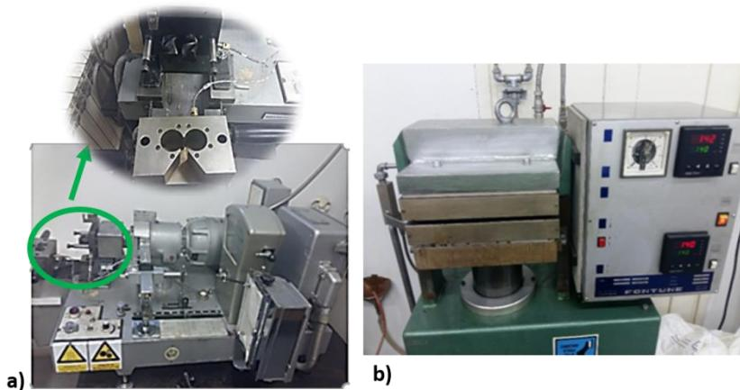
*Slika 19.* a) Laboratorijska Brabender gnjetilica i b) hidraulička preša Fortuna Holland
