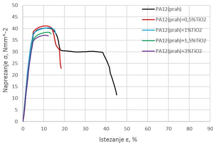
**Slika 33.** Grafička ovisnost naprezanja o istezanju PA12/TiO<sub>2</sub> nanokompozita pripravljenih prešanjem iz praha
