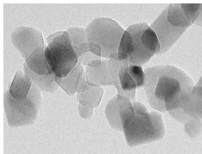
**Slika 18.** TEM snimka AEROXIDE® TiO<sub>2</sub> P25<sup>30</sup>
