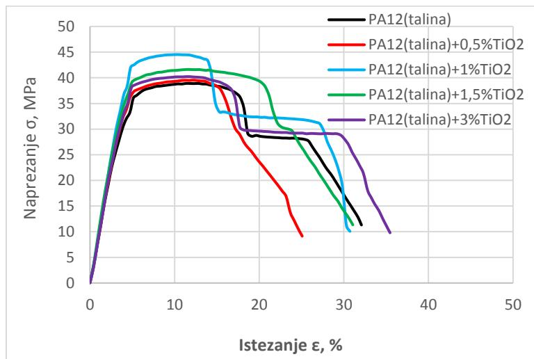
**Slika 34.** Grafička ovisnost naprezanja o istezanju PA12/TiO<sub>2</sub> kompozita pripravljenih prešanjem iz taline
