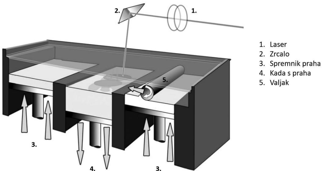
*Slika 5.* Shematski prikaz SLS procesa<sup>15</sup>
