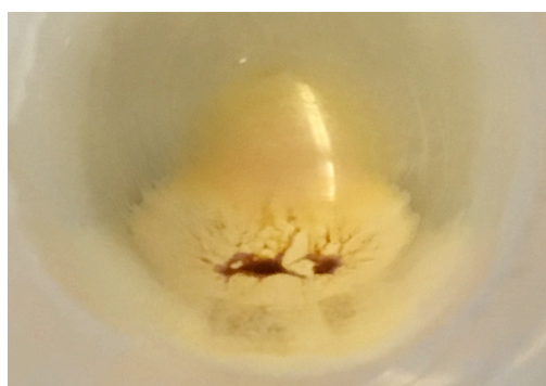
Slika 5.4. Odvajanje željeza prilikom centrifugiranja uzorka B3 (5% \text{Fe}^{3+} iona).
