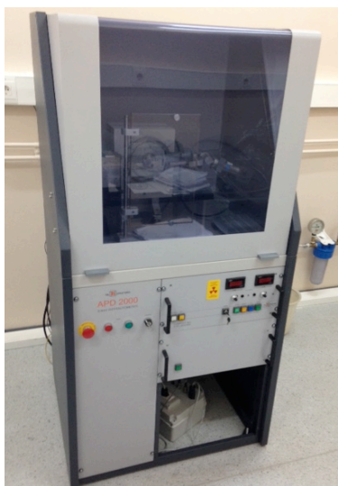
Slika 3.5. Difraktometar APD 2000 proizvođača Ital Structures®.
