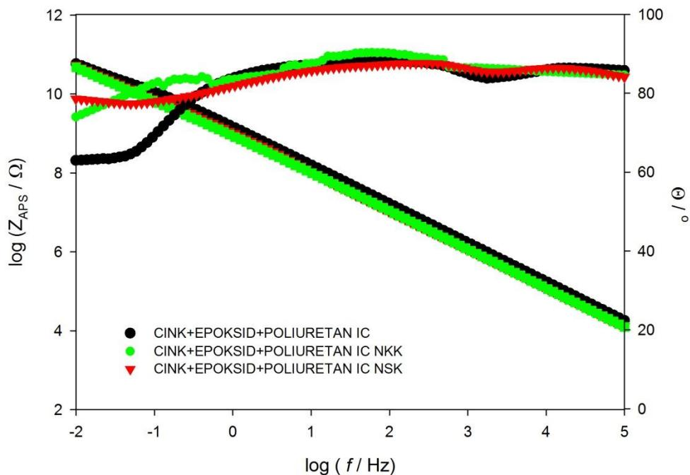
Slika 35. Bodeov grafički prikaz za testne pločice 7, 8, 9
