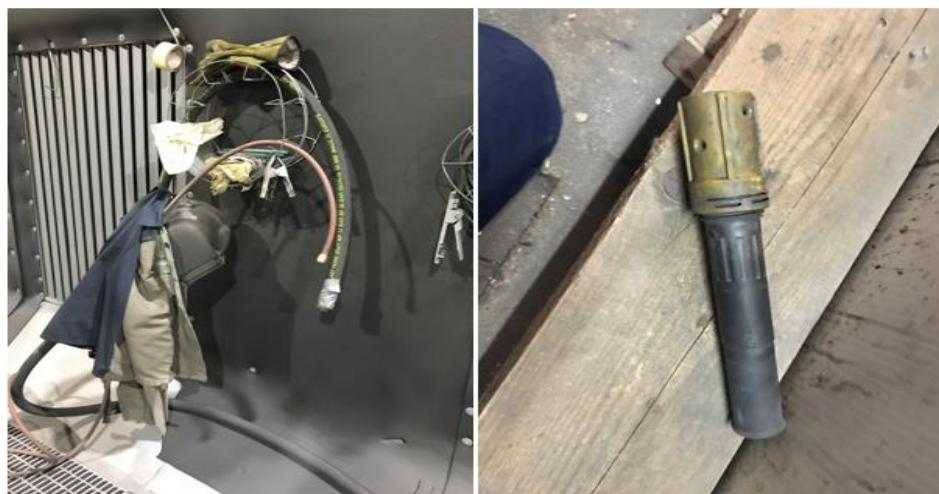
*Slika 20. Alat za sačmarenje čelične površine*
