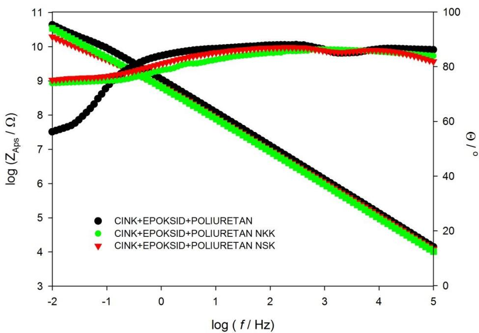
Slika 14. Bodeov grafički prikaz za testne pločice 10, 11, 12
