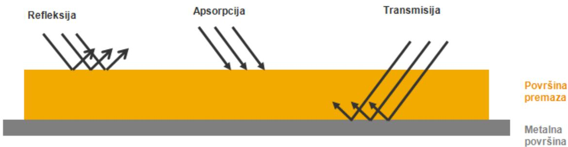
Slika 8. Sušenje premaza pomoću IC zračenja
