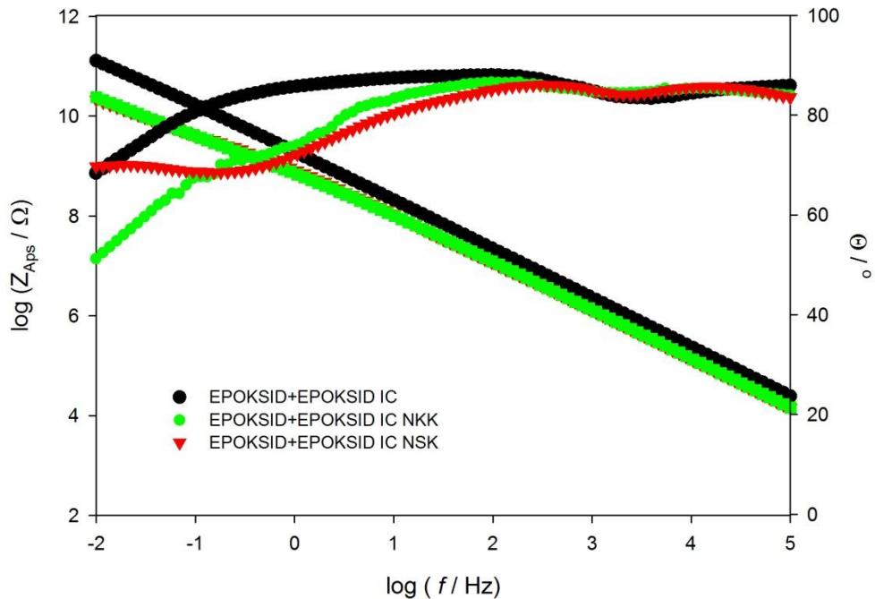
Slika 16. Bodeov grafički prikaz za testne pločice 31, 32, 33
