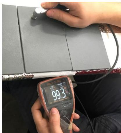
Slika 28. Određivanje DSF pomoću uređaja Elcometer 456
