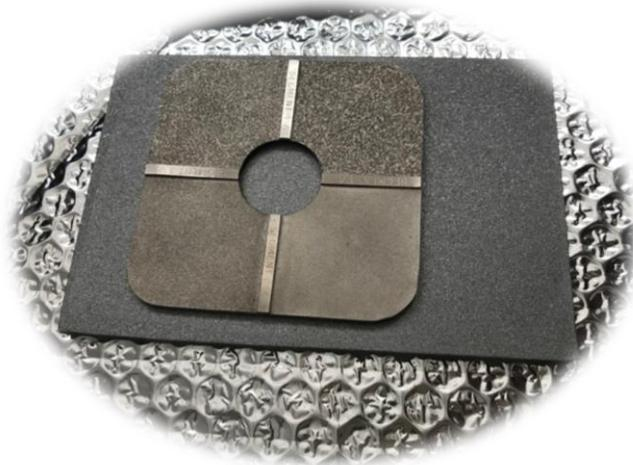
*Slika 21. Određivanje hrapavosti površine pomoću uređaja Elcometar grit*
