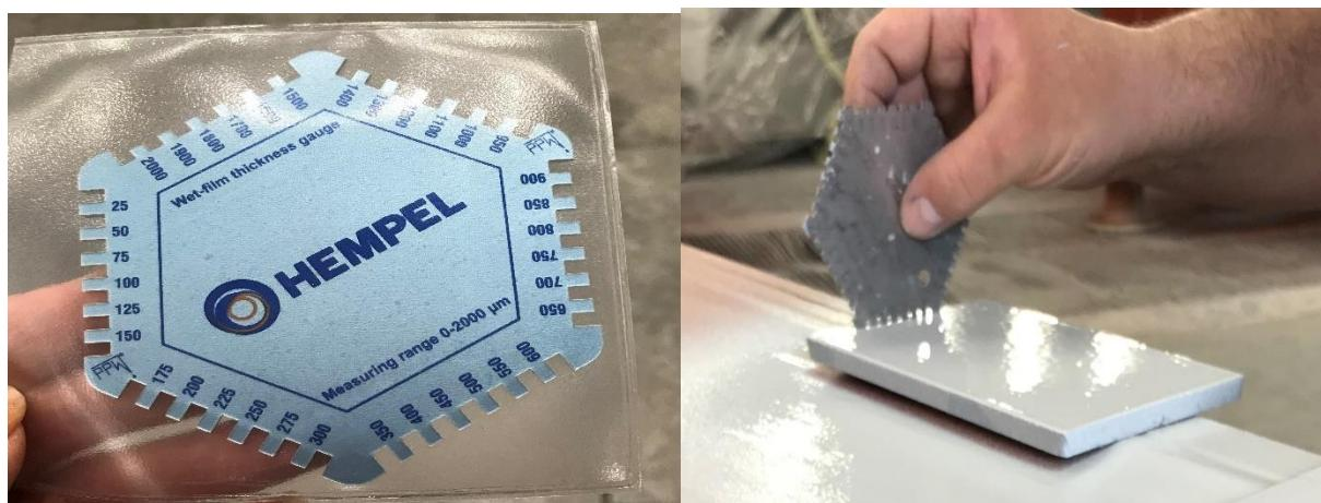
*Slika 26. Mjerjenje debljine mokrog filma premaza (DMF) češljem*
