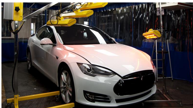
Slika 11. IC sušenje premaza automobila
