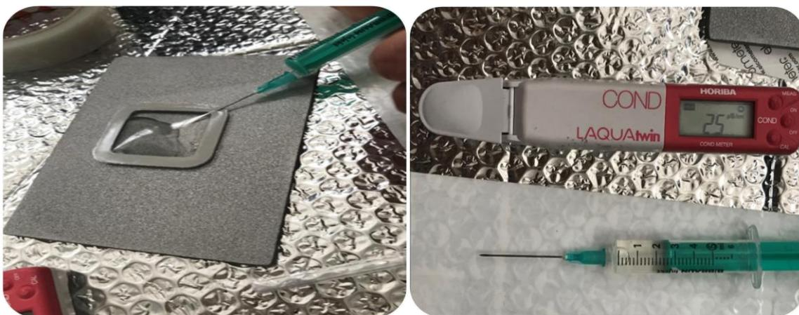
Slika 23. Određivanje slanosti površine
