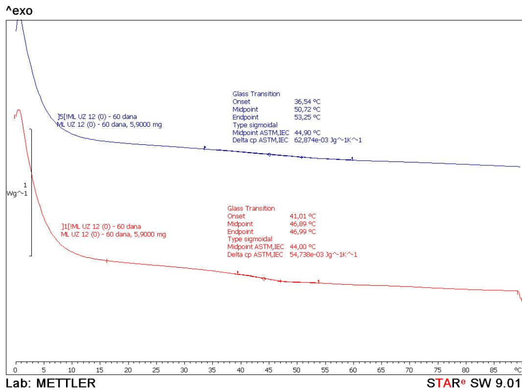
Slika 45. Termogram uzorka 12
