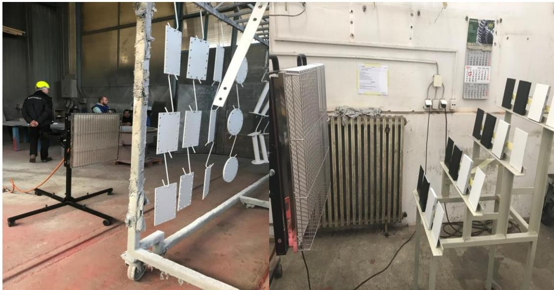
*Slika 10 Primjena IC zračenja za sušenje premaza*
