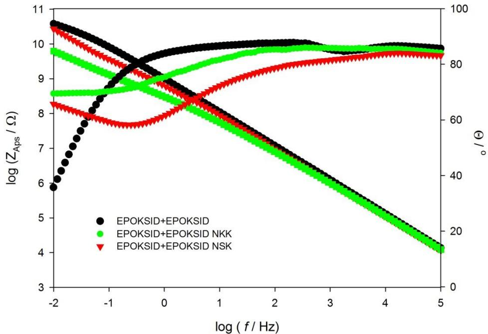
Slika 39. Bodeov grafički prikaz za testne pločice 16, 17, 18
