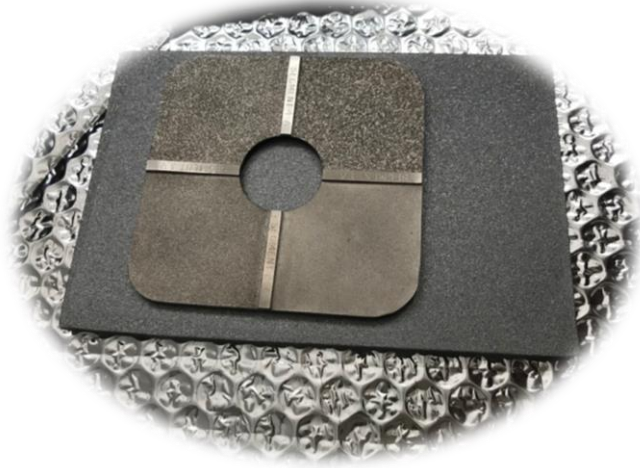
Slika 21. Određivanje hrapavosti površine pomoću uređaja Elcometar grit
