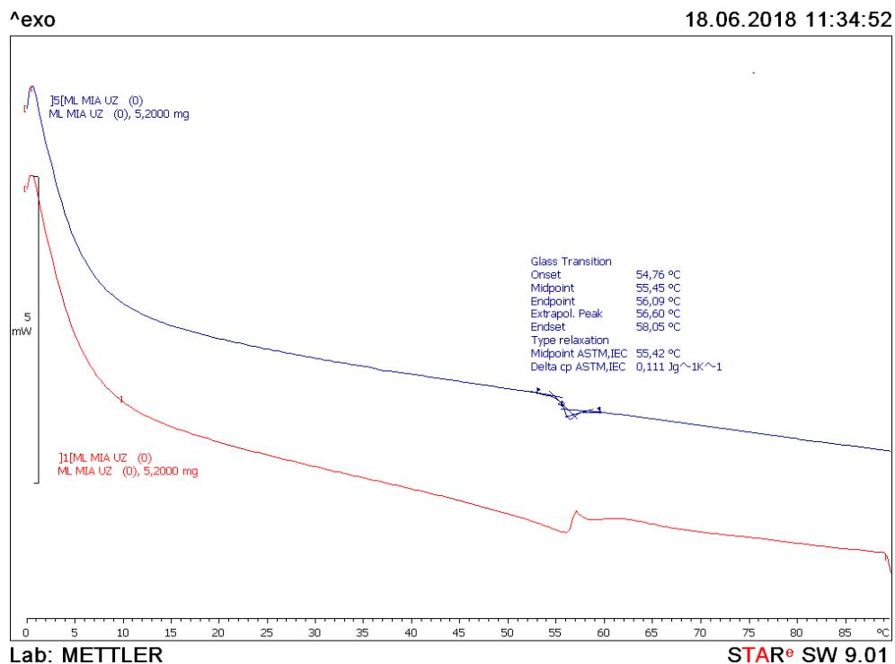
Slika 40. Termogram uzorka 7
