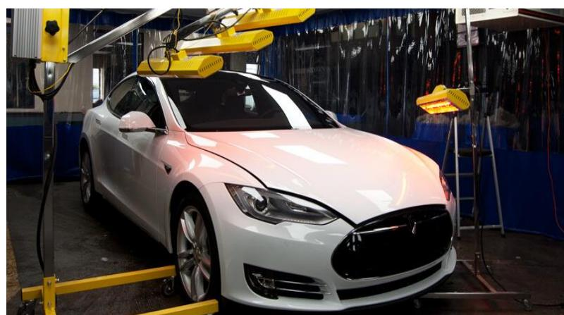
*Slika 11. IC sušenje premaza automobila*
