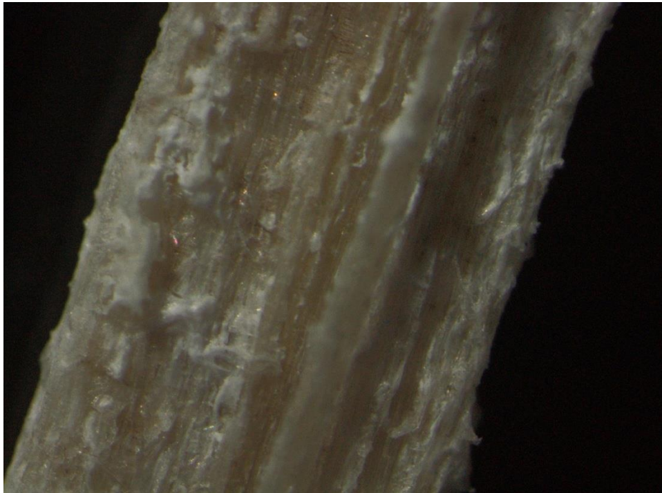
Slika 23. Drvce tretirano jednim ciklusom i snimano stereo mikroskopom
