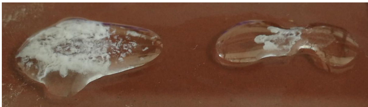
Slika 16. Dobivanje aluminijevog fosfata iz aluminijevog sulfata-18-hidrata i di-amonijevog hidrogen fosfata
