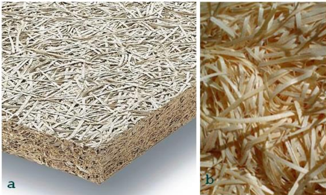
Slika 6. Drvo-cementni kompozit 16 (a) i drvena vuna (b) 15
