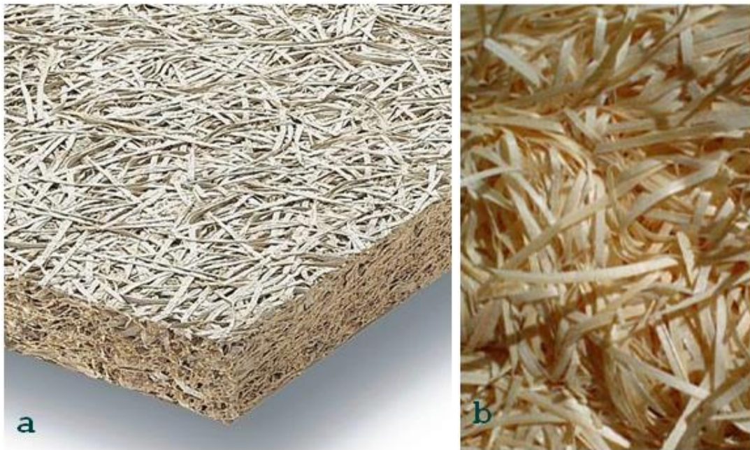
Slika 6. Drvo-cementni kompozit 16 (a) i drvena vuna (b) 15
