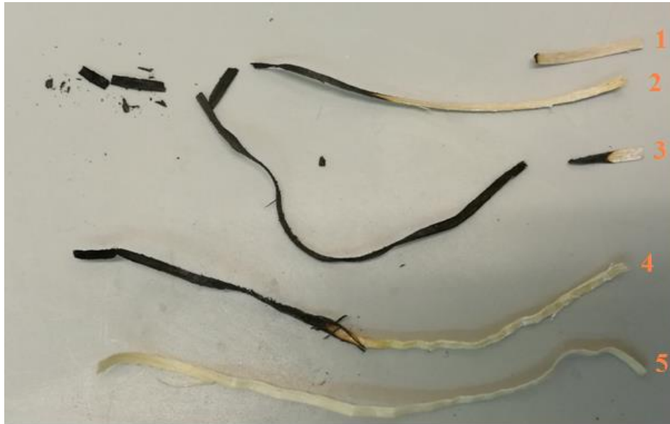
Slika 18. Uspredba netretiranih te tretiranih i paljenjih vlakna drvene vune
